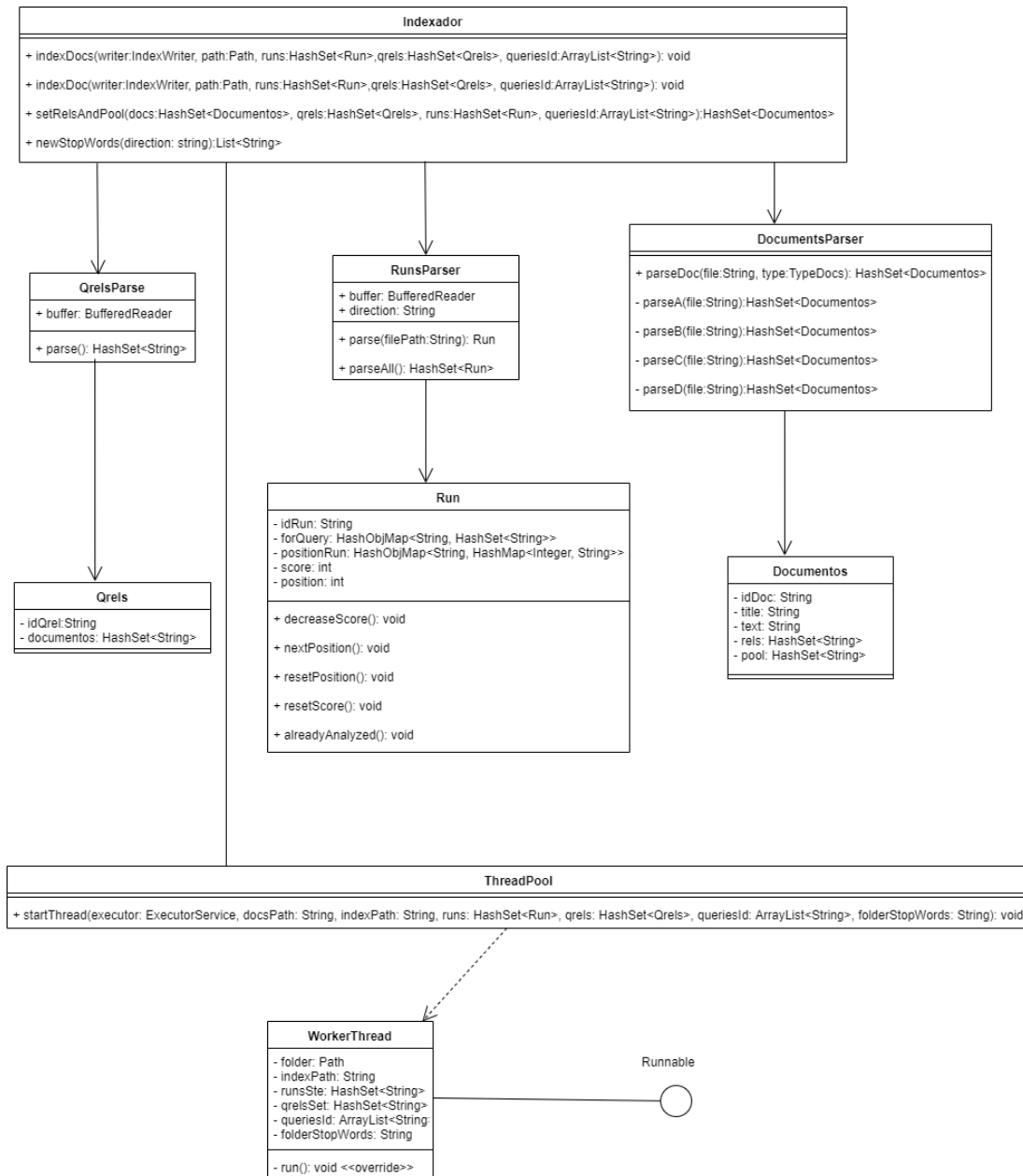
Figura 4.3: Diagrama UML del componente Indexador.
