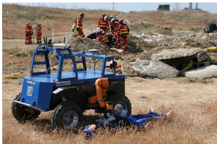
Figura 1: Ejemplo de atención a una víctima con el UGV Rambler durante unas maniobras de respuesta a emergencias.
