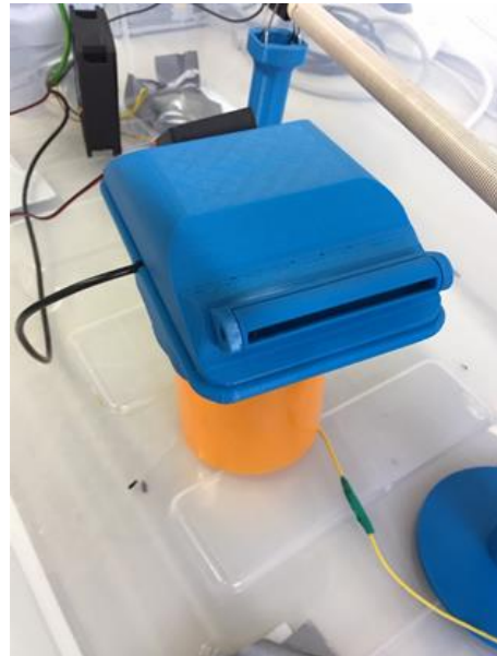
Figura 4: Dispositivo humidificador impreso en 3D.
