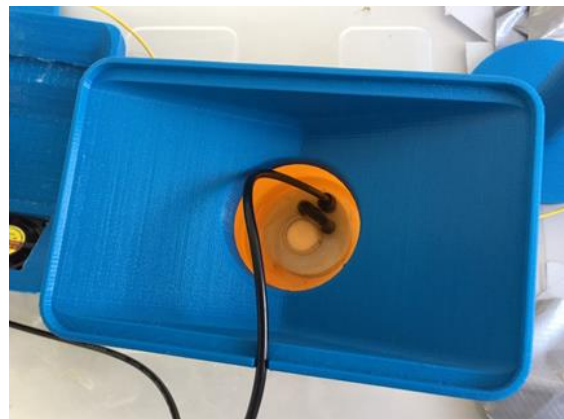
Figura 5: Vista del alojamiento del transductor piezoeléctrico en el humidificador.
