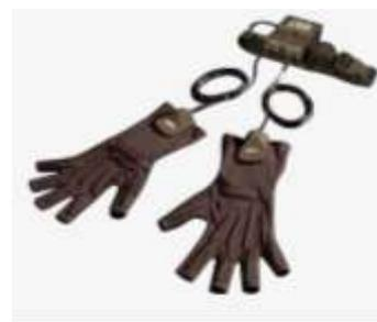
Figura 6: Guantes de datos con 5 sensores de flexión
