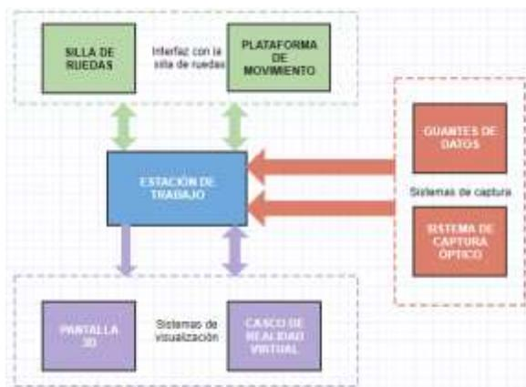
Figura 1: Simulador y equipos que lo conforman
