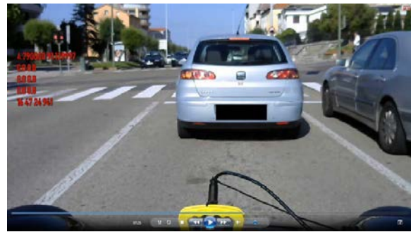
Figura 3. Información en pantalla de los datos de radar y de tiempo.
