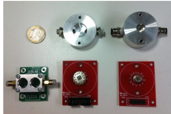
Figura 3: Celdas de los sensores. Izquierda: e2v, centro: sensor CNM, derecha: sensor MICROSENS
