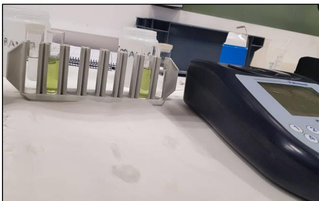
Figura 15. Rejilla con muestras donde se está realizando la medición de alcalinidad con Palintest.
