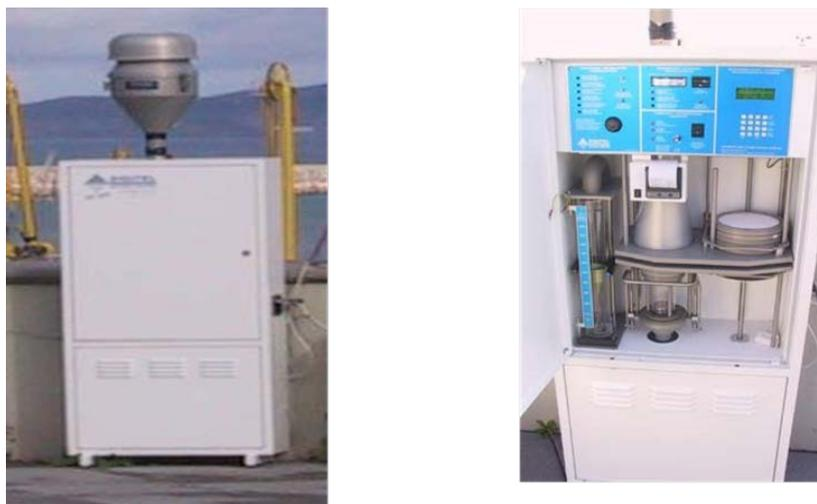
Figura 10. Muestreador DIGITEL DHA-80 visto desde fuera (1ª fotografía) y por dentro (2ª fotografía) <sup>42</sup>.
