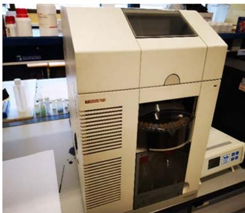
*Figura 11. Equipo de EC HP<sup>3D</sup>CE.*
