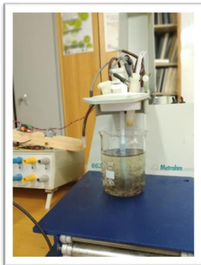
Figura 7: Sistema agitador provisto de un motor eléctrico.
