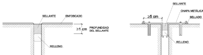
Figura 2.6 Ejemplos de juntas de dilatación
