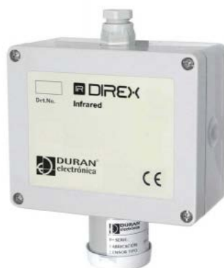
Figura 8.1.3.1- Sensor DIREX CO 2 . (Durán Electrónica)
