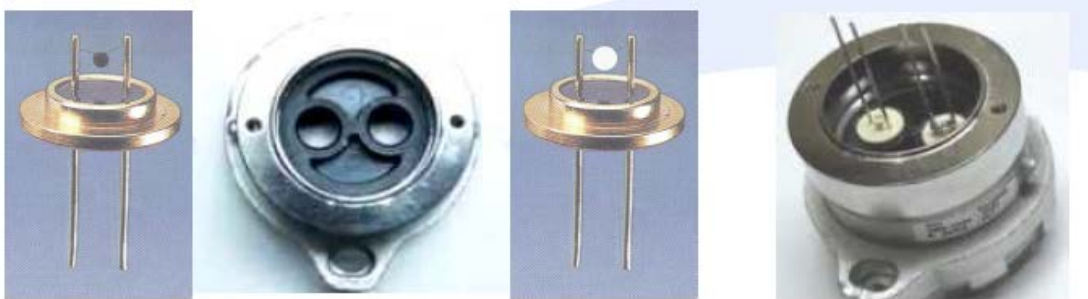
Figura 2.3.4.6.3-Sensor oxidación catalítica. (Iván Ruiz, 2013)
