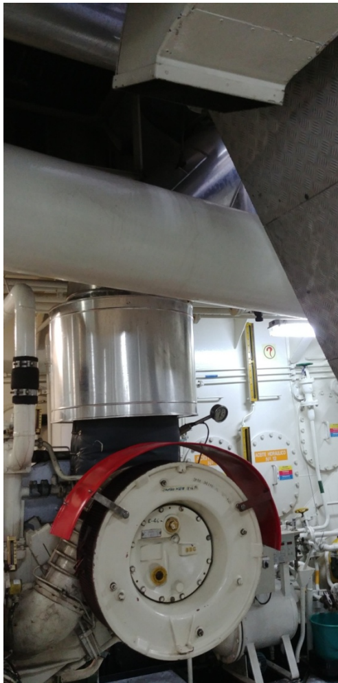
Figura 2.3.8.3- Ventilación de la turbo del motor principal. (Original del autor)
