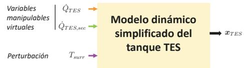
Figura 4: Modelo simplificado del sistema
