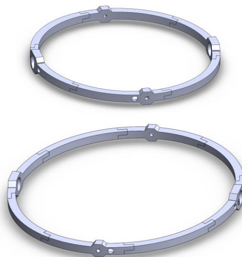
Figura 3: Descomposición de piezas de los anillos para la impresión 3D; arriba anillo interior, abajo anillo exterior.
