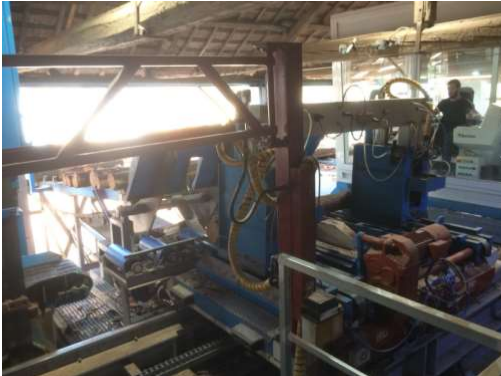
Figura 33: Máquina serradora de troncos de 2 metros. (Fuente: Elaboración propia)
