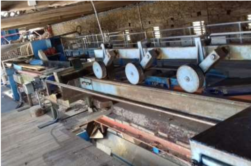
Figura 37: Conveyor para el transporte de tablas de 2 metros hasta la retestadora. (Fuente: Elaboración propia)
