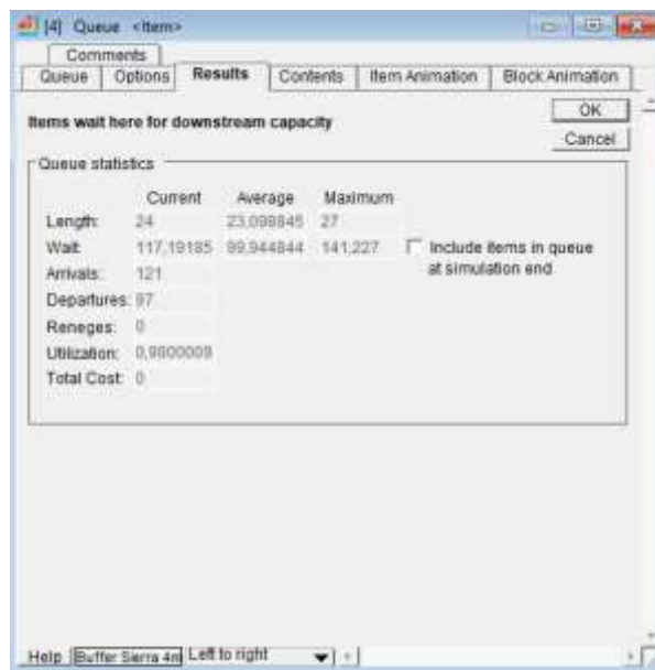
Figura 82: Utilización del buffer de troncos de 4 metros. (Fuente: Elaboración propia)
