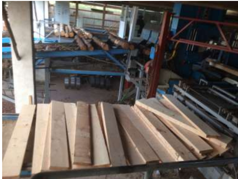
Figura 39: Buzón donde se almacena la pavia hasta su posterior secado y apilado. (Fuente: Elaboración propia)
