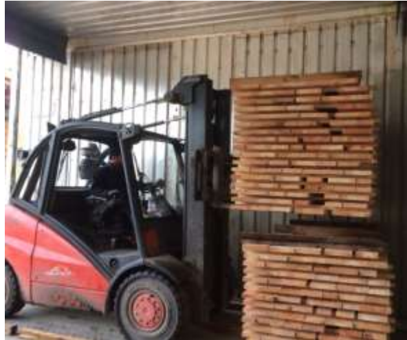
Figura 44: Separadores de madera para el apilado. (Fuente: Elaboración propia)
