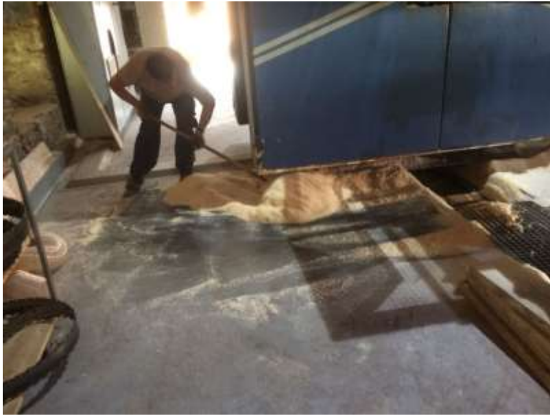
Figura 91: Operario de la canteadora mal situado solucionando problema en el tándem. (Fuente: elaboración propia)
