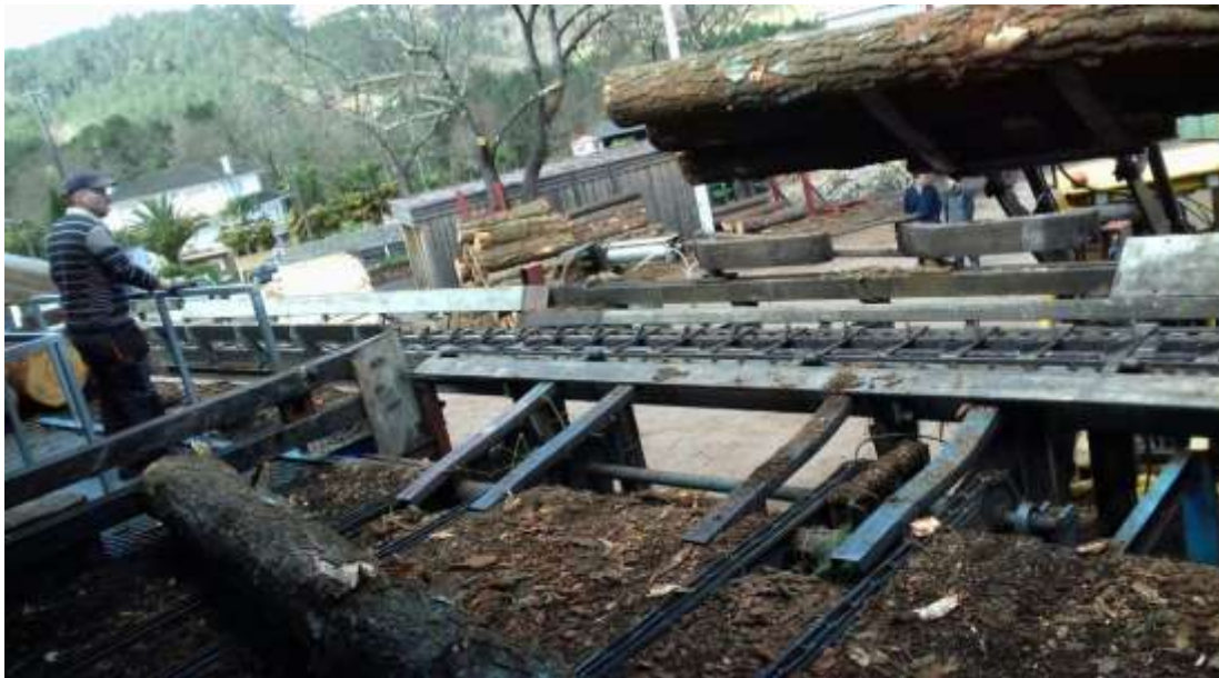
Figura 25: Introducción de troncos al sistema en la entrada secundaria de 4 metros. (Fuente: Elaboración propia)
