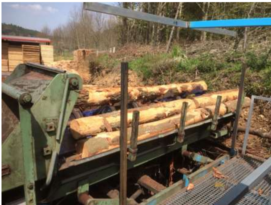
Figura 92: Problema típico donde entran dos troncos a la vez, cuando solo uno puede entrar. (Fuente: Elaboración propia)
