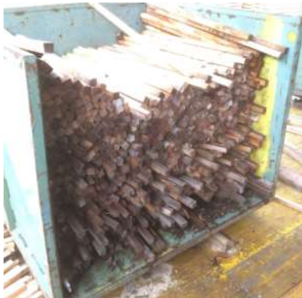
Figura 45: Introducción de piezas previamente apiladas en el secadero. (Fuente: Elaboración propia)
