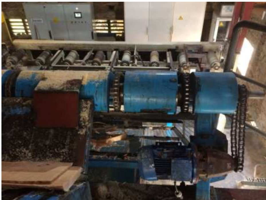
Figura 32: Conveyor para el transporte de tablas de 2 metros hasta el buffer de la canteadora. (Fuente: Elaboración propia)
