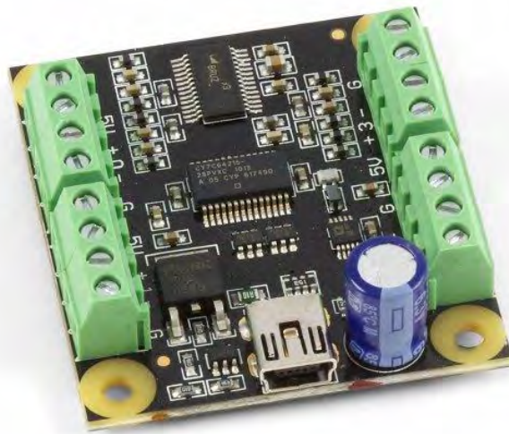
Ilustración 12: Phidget Bridge, amplificador de puente de Wheatstone
