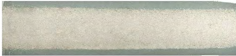
Ilustración 3: Perfil de contenedor con núcleo de EPE
