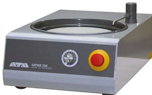
Imagen 15.12: Pulidora manual Neurtek Saphir 320
