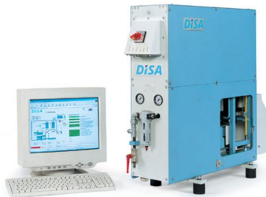
Imagen 15.6: Multicontrolador DISA SMC
