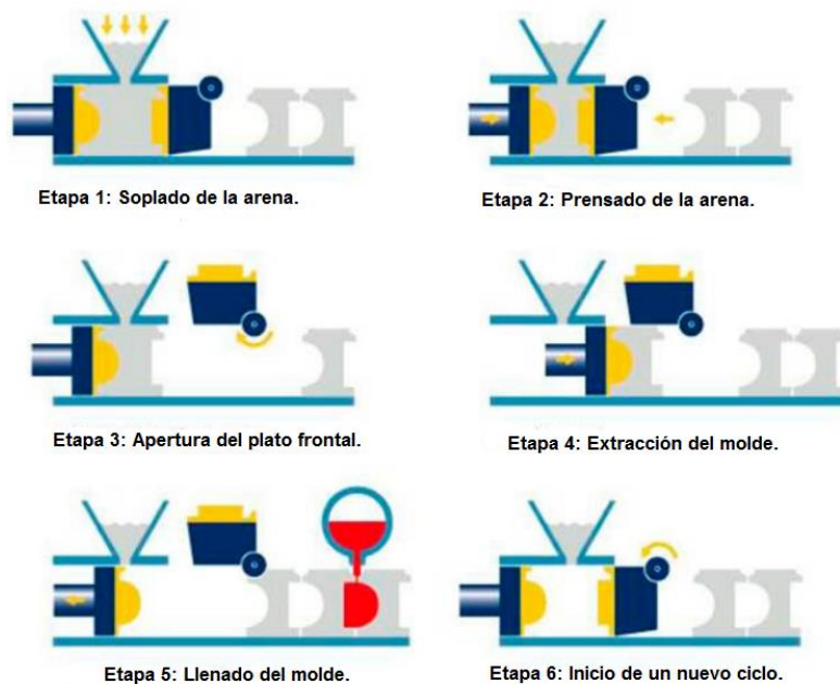
Imagen 9.16: Etapas en la fabricación de los moldes.
