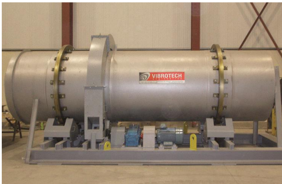
Imagen 11.1: Tambor de desmoldeo Vibrotech.
