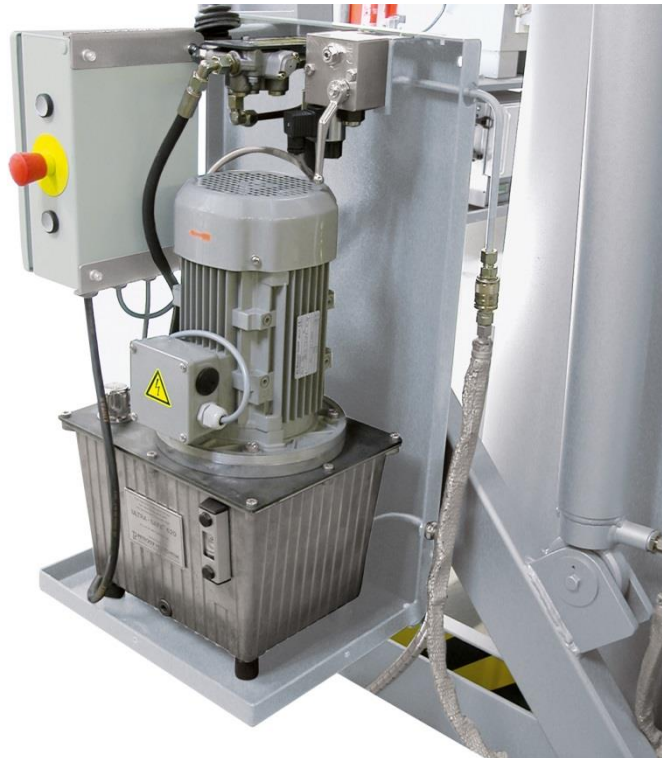
Imagen 8.9: Grupo hidráulico para la basculación del horno
