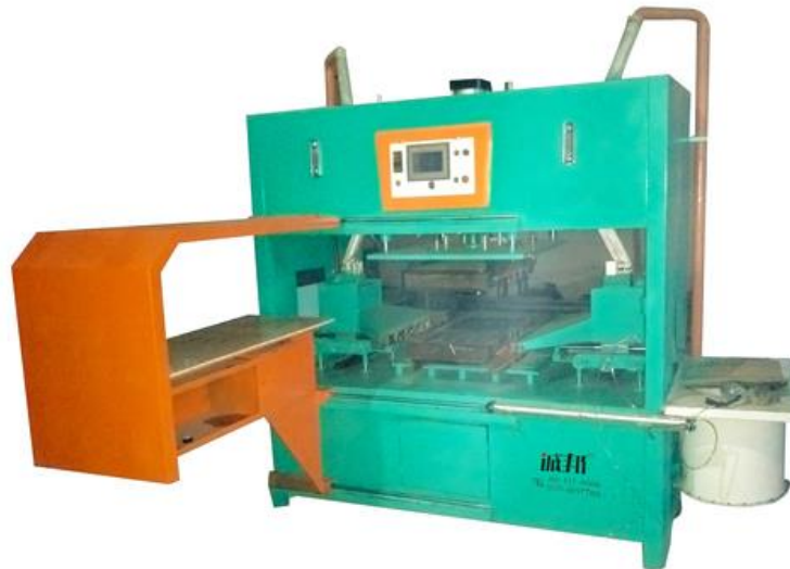
Imagen 9.9: Disparadora de machos en caja caliente.
