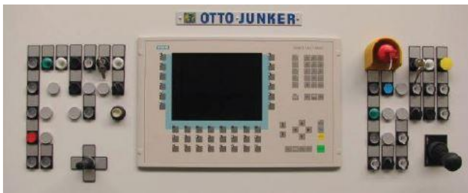
Imagen 10.5: Panel de control del operario
