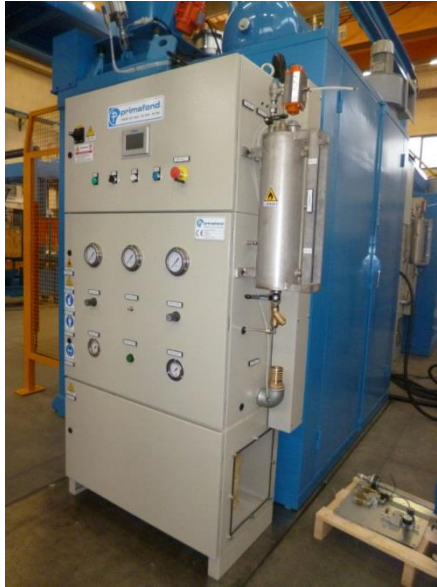
Imagen 9.13: Gasificador GCB para Caja Fría.
