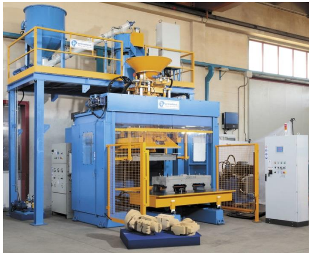
Imagen 15.7: Disparadora de machos con mezclador en la parte superior Primafond.
