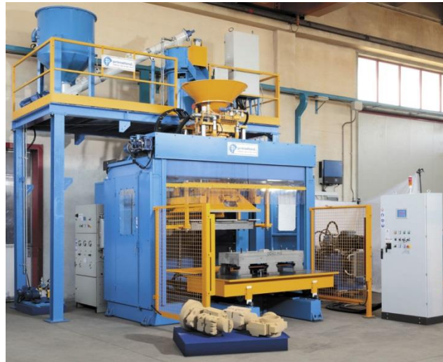
Imagen 9.11: Instalación Primafond de disparadora de machos y molino mezclador.
