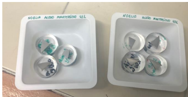
Figura 38 muestras desbastadas y pulidas. Fuente: elaboración propia
