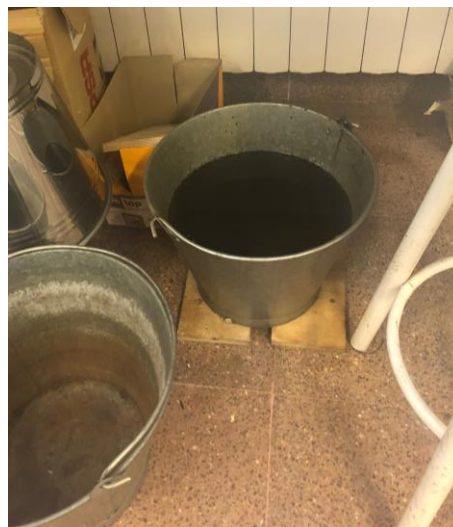
Figura 34 Aceite sin agitación usado en el temple Fuente: elaboración propia
