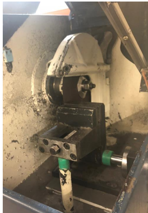
Figura 35 cortadora metalográfica de la marca TECNICUT de TECNIMETAL Fuente: elaboración propia
