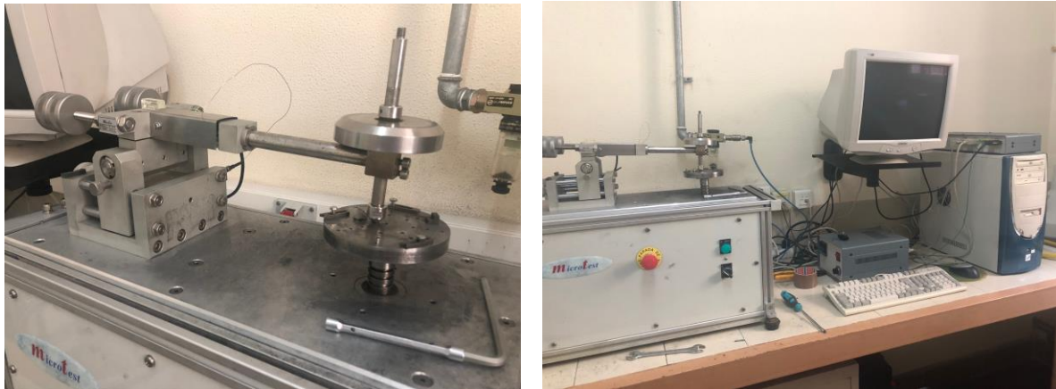
Figura 42 Máquina de ensayo de desgaste Pin on disk. Fuente: elaboración propia
