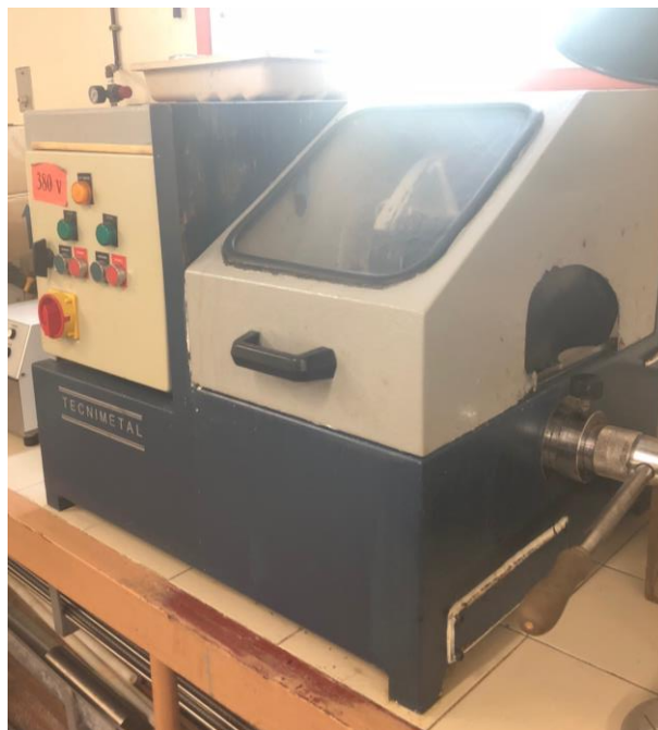
Figura 35 cortadora metalográfica de la marca TECNICUT de TECNIMETAL Fuente: elaboración propia
