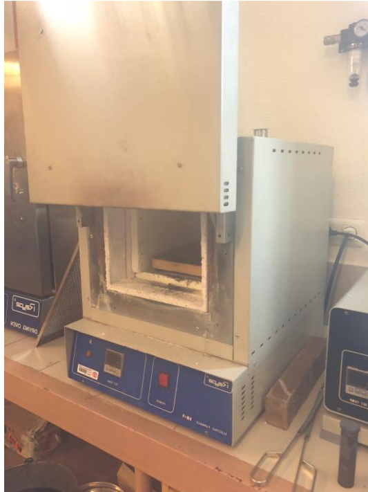
Figura 33 Horno donde se han realizado los tratamientos térmicos Fuente: elaboración propia
