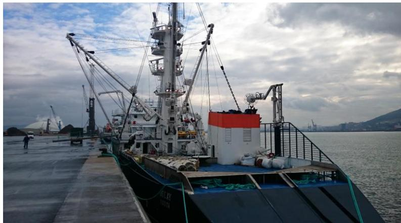
Imagen 1. Rampa de popa, estiba de red y guardacalores
