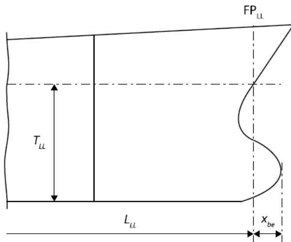
La eslora Lf viene definida en el DNV ( Pt3 Ch1 Sec 4) como la eslora en la flotación al 96% del puntal, o bien desde la cara de proa de la roda hasta el eje de la mecha del timón para dicha flotación, en caso de que esta sea mayor
