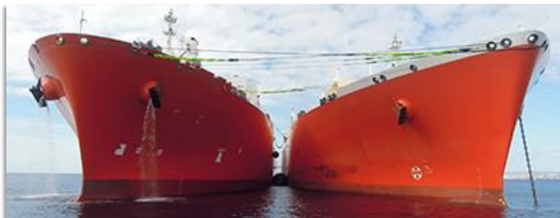
Imagen 52: Defensas primarias flotando en el agua y las secundarias en los finos del buque de estribor.
