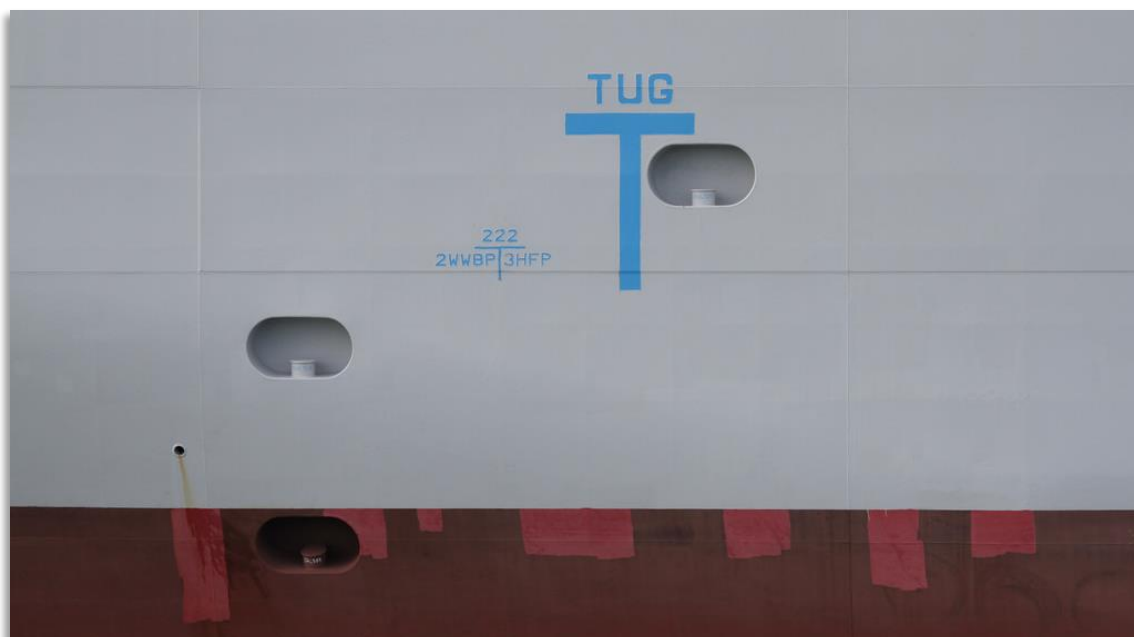
Imagen 57: Sunken bit en diferentes posiciones del casco de un buque.
