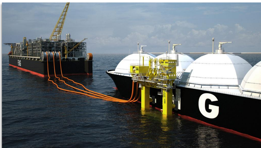
Imagen 17: Mangueras criogénicas flotantes.
