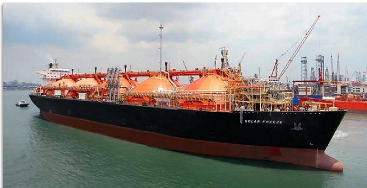
Imagen 24: Buque Golar Freeze con tanques esféricos tipo Moss Rosenberg.
