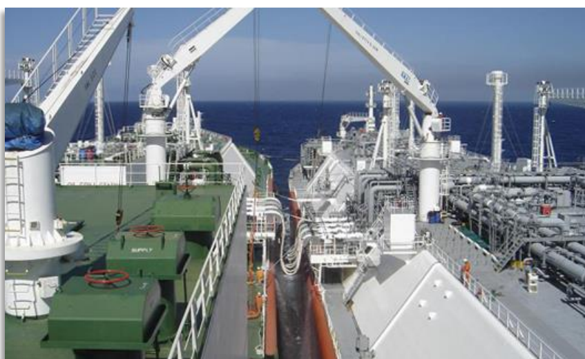
Imagen 61: Operación de transferencia mediante el uso de mangueras criogénicas.
