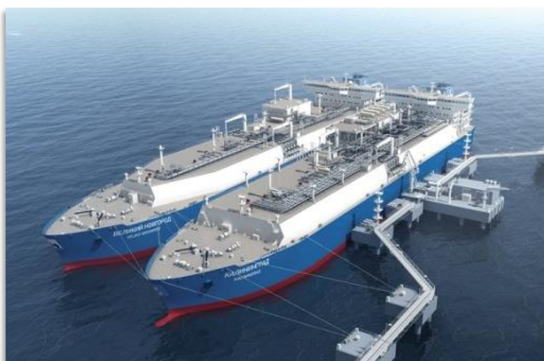
Imagen 43: Disposición con buque FSRU amarrado a tierra.
