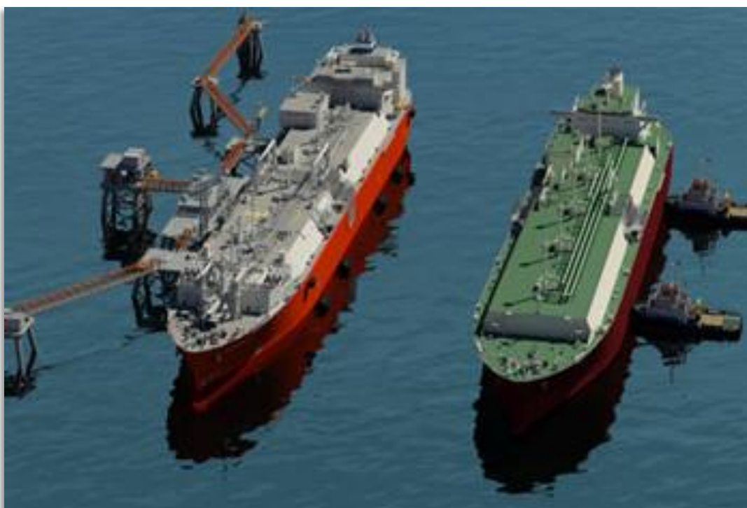
Imagen 55: Remolcadores asistiendo al buque GNL convencional durante la maniobra..
