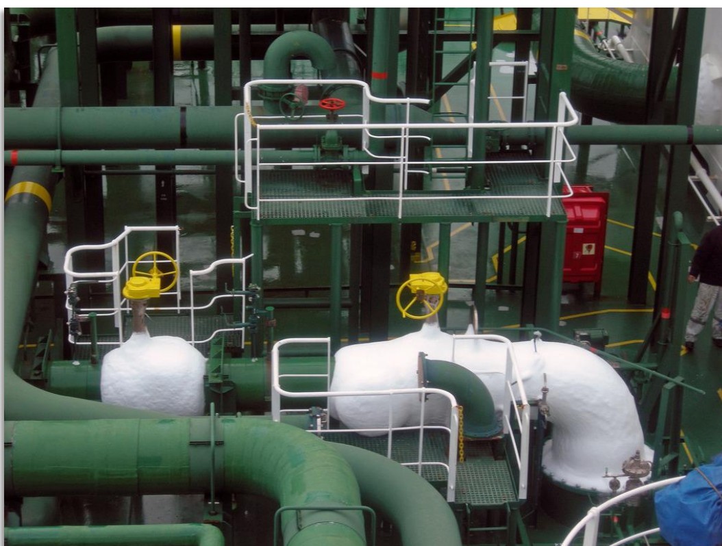
Imagen 65: Formación de hielo y escarcha sobre las líneas
