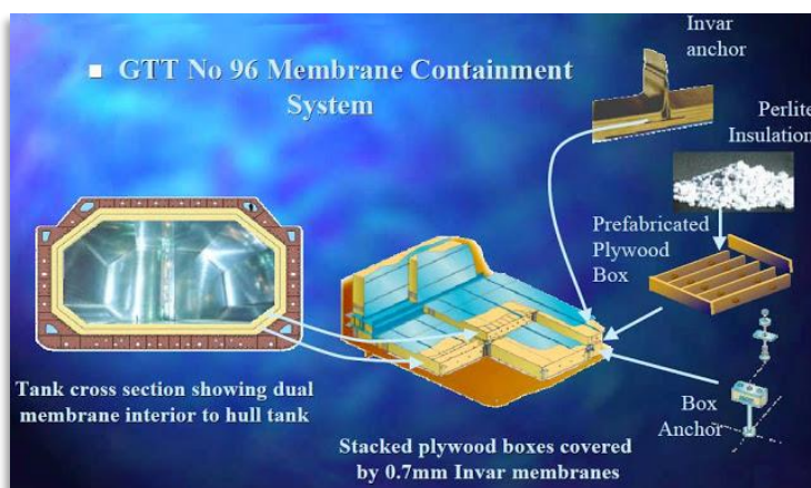
Imagen 26: Sistema de aislamiento de membrana.
