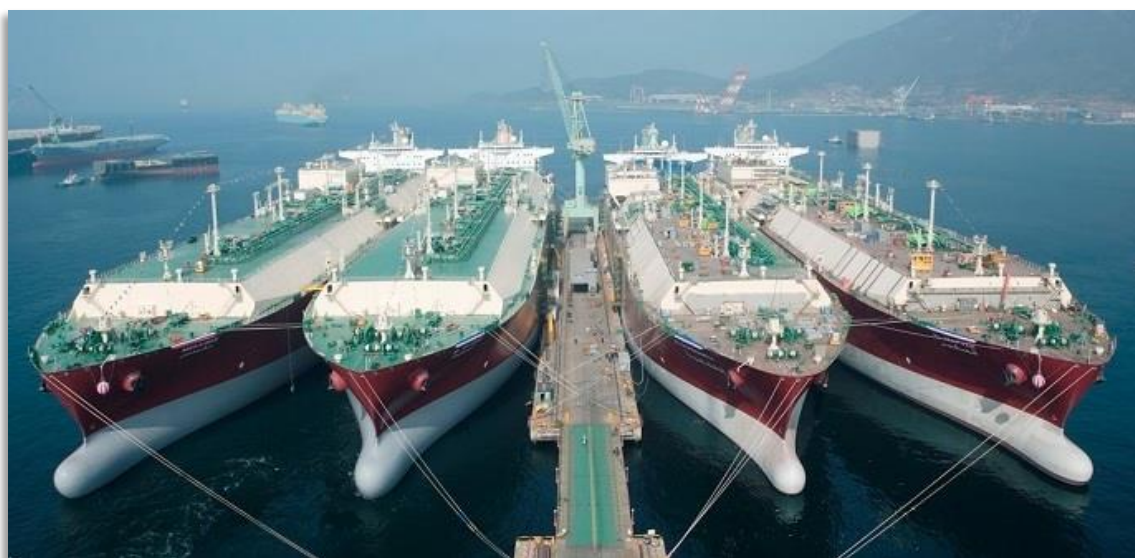
Imagen 63: Operaciones de transferencia entre buques GNL y FSRU.
