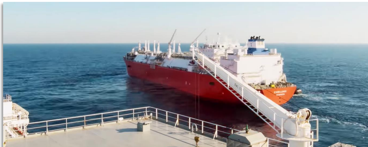
Imagen 54: Defensa secundaria dispuesta en los finos de proa del buque GNL libre por el costado.
