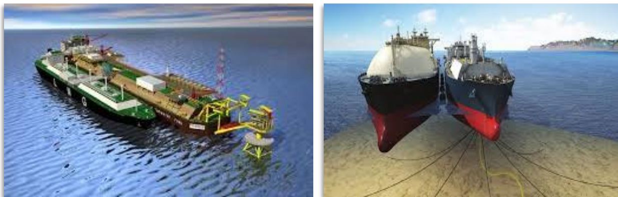
Imagen 45: Sistema de amarre tower yake (izda) y de amarre de torre sumergida (dcha).
