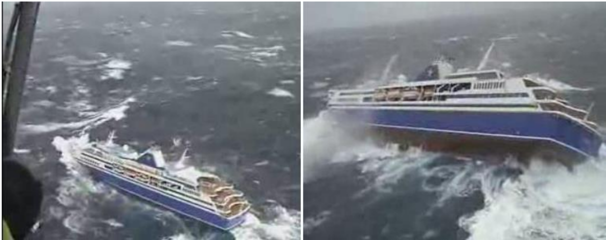
Figura 2.12 Voyager intentando combatir una tormenta (resonancia paramétrica) https://www.youtube.com/watch?v=tVoMtPFtEg0 [En línea, 22 de Noviembre de 2017]
