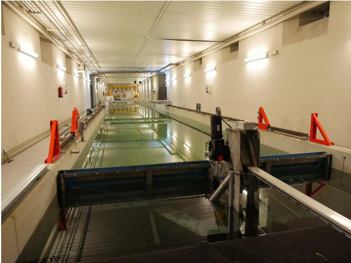
Figura 3.48 Pala generadora de olas y carro dispuesto en el centro del canal
