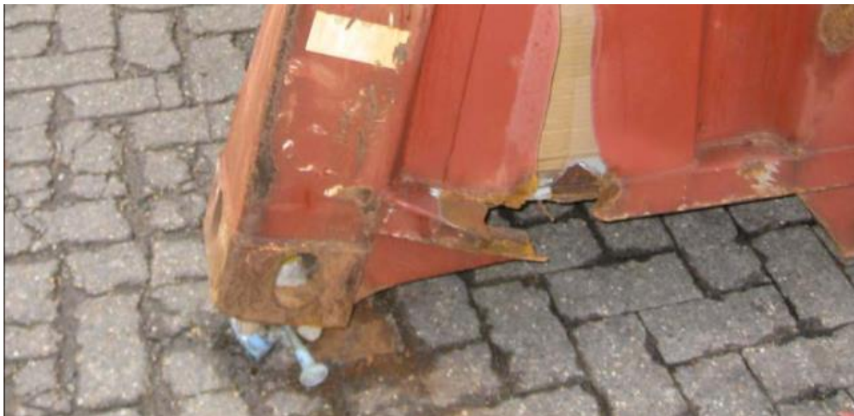
Figura 2.9 Daños en el Svendborg Maersk producidos por resonancia paramétrica [21]
