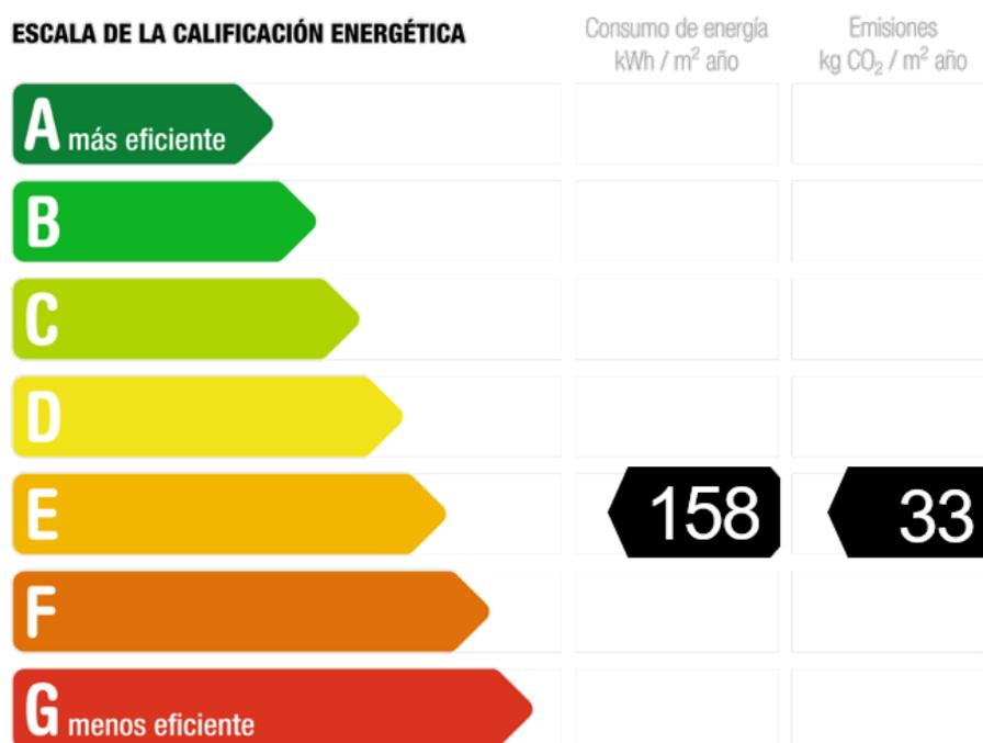
Figura 124. Etiqueta de certificación energética según los valores obtenidos en CE3X. Fuente: propia
