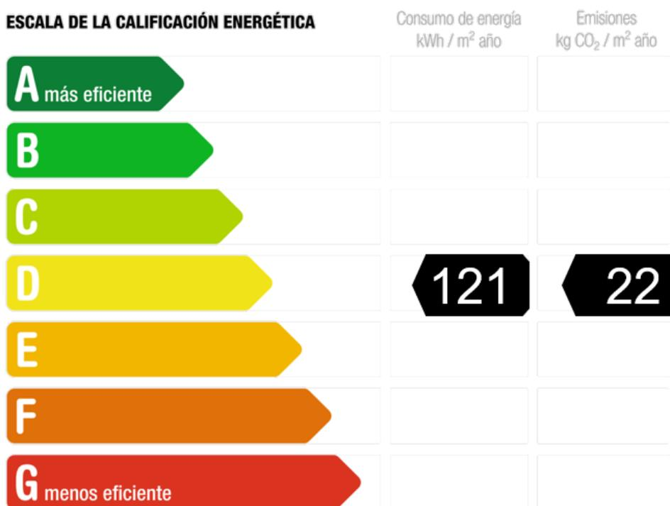
Figura 122. Etiqueta de certificación energética según los valores obtenidos en ArchiCAD. Fuente: propia
