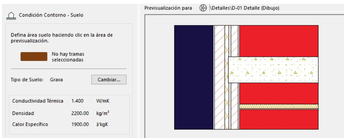
Figura 68. Parámetros de terreno en el puente térmico. Fuente: propia
