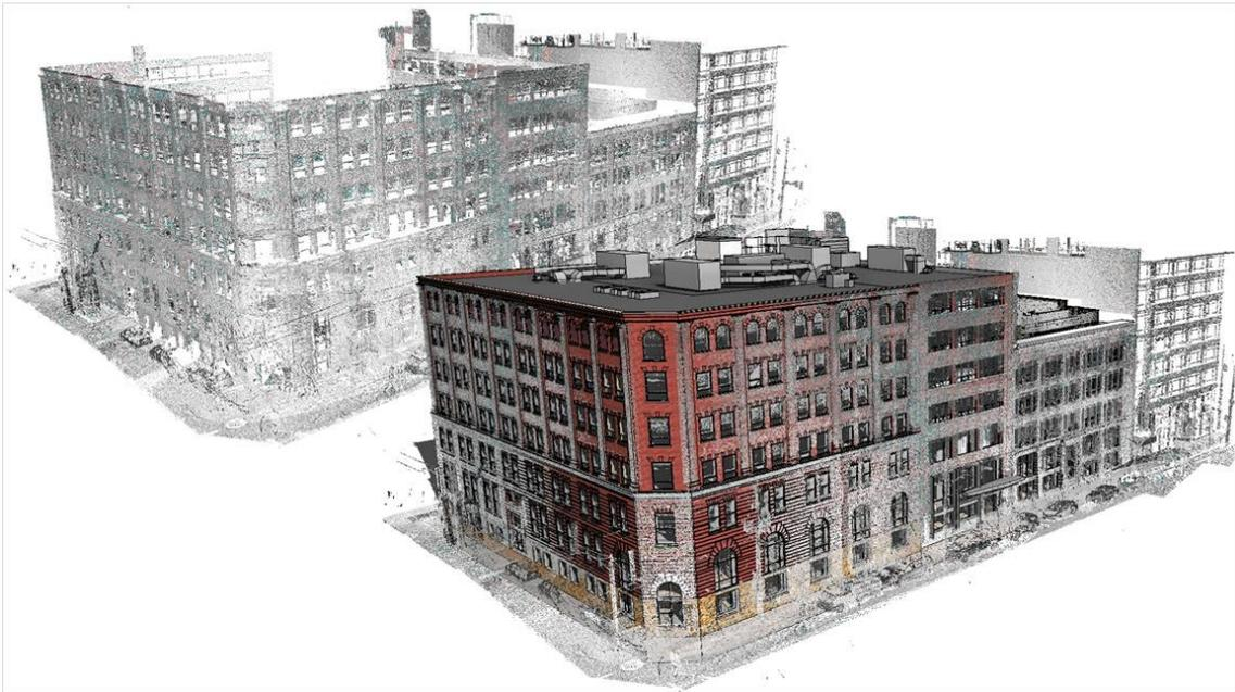
Figura 2. Nube de puntos de una serie de edificios existentes. Fuente: <http://www.mtechthailand.com/files/9813/7240/5984/point-cloud-improvements-large-1152x648.jpg>
