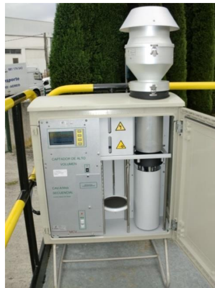
Figura 2: Captador gravimétrico de filtros de 47mm situado en La Grela.
