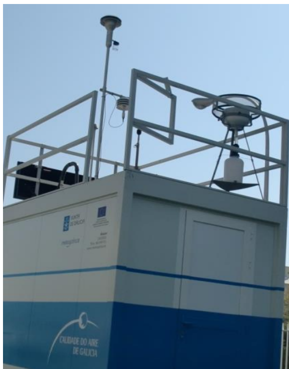
Figura 15: Estación de calidad del aire donde se observa un captador de deposición.
