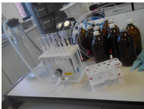
Figura 26: Sistema de extracción conectado a vacío.
