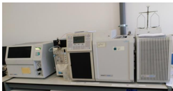
Figura 27: Automuestreador conectado a un CG/MS
