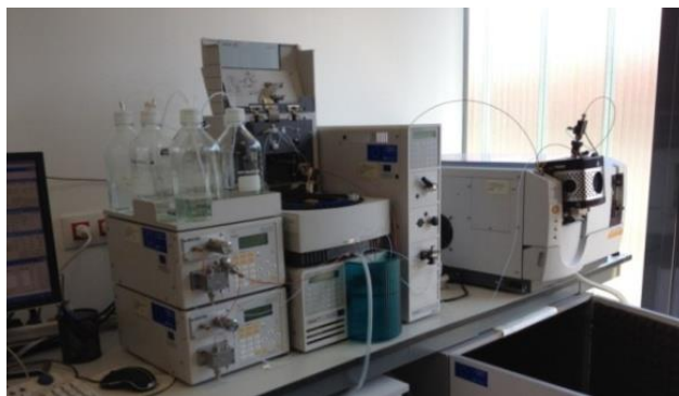
Figura 25: HPLC acoplado a espectrómetro de masas
