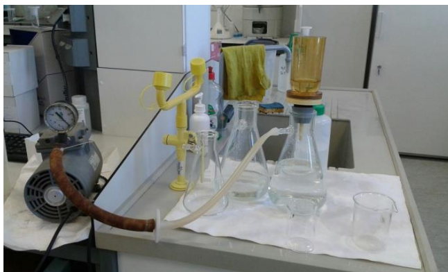
Figura 16: Sistema de filtración.
