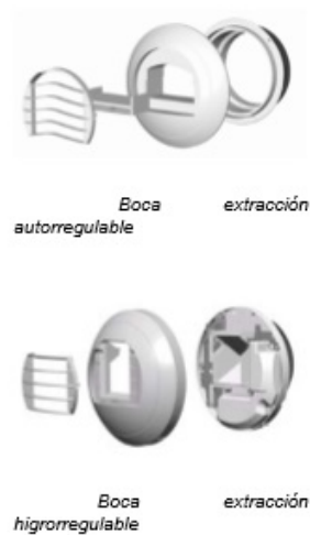
Figura 3.3.3.7 – Bocas de extracción de aire
