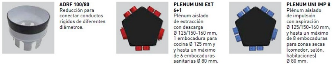
Figura 3.3.11.5 – Plénium impulsión y extracción
