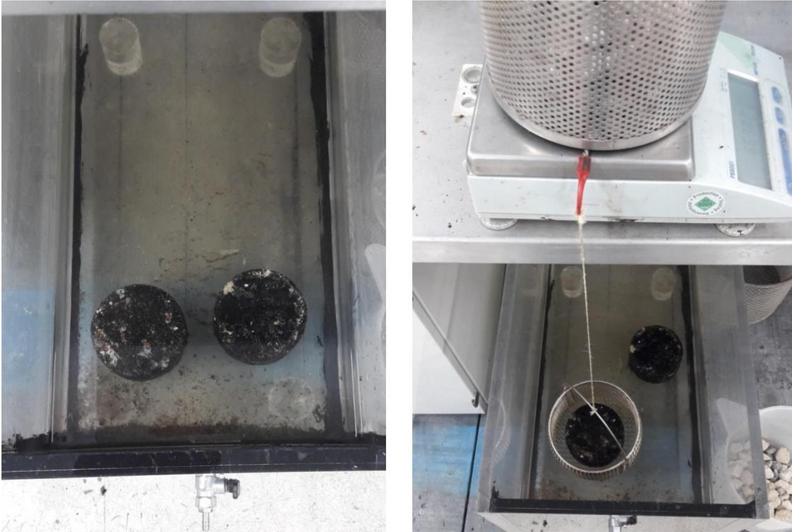
Figura 5. 1. Determinación de la densidad aparente de las probetas. Detalle de las probetas saturándose en el baño de agua y de la pesada sumergida.
