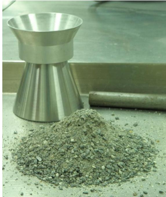
Figura 3. 2. Obtención de la densidad de la fracción 0/4 mm del árido natural.
