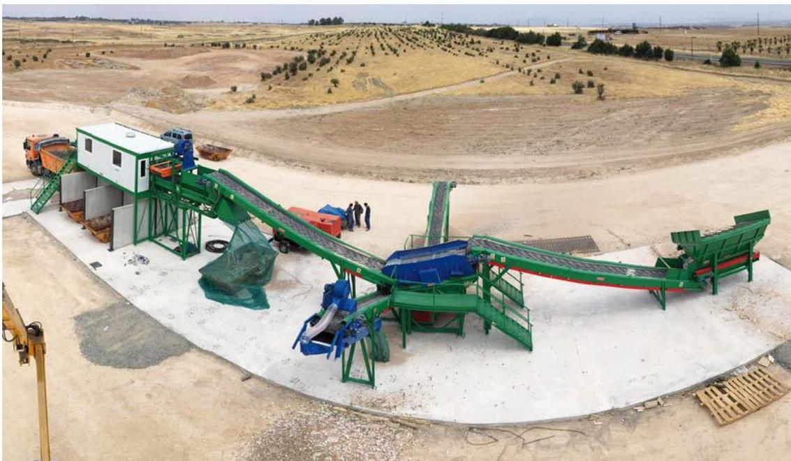
Figura 2. 4. Planta de valorización semimóvil en la zona sur de Cáceres..
