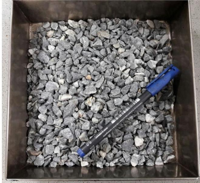
Figura 3. 1. Fracción 4/8 mm de la corneana utilizada.
