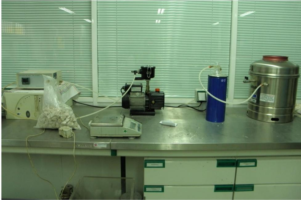
Figura 6. 1. Equipo de vacío. Consta, de izquierda a derecha, de un controlador del vacío, una bomba, un vaso Dewar y un recipiente de vacío.
