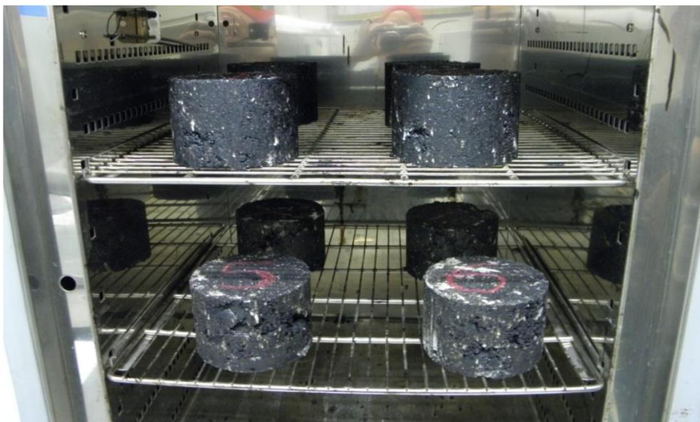
Figura 5. 9. Curado en estufa de las probetas.
