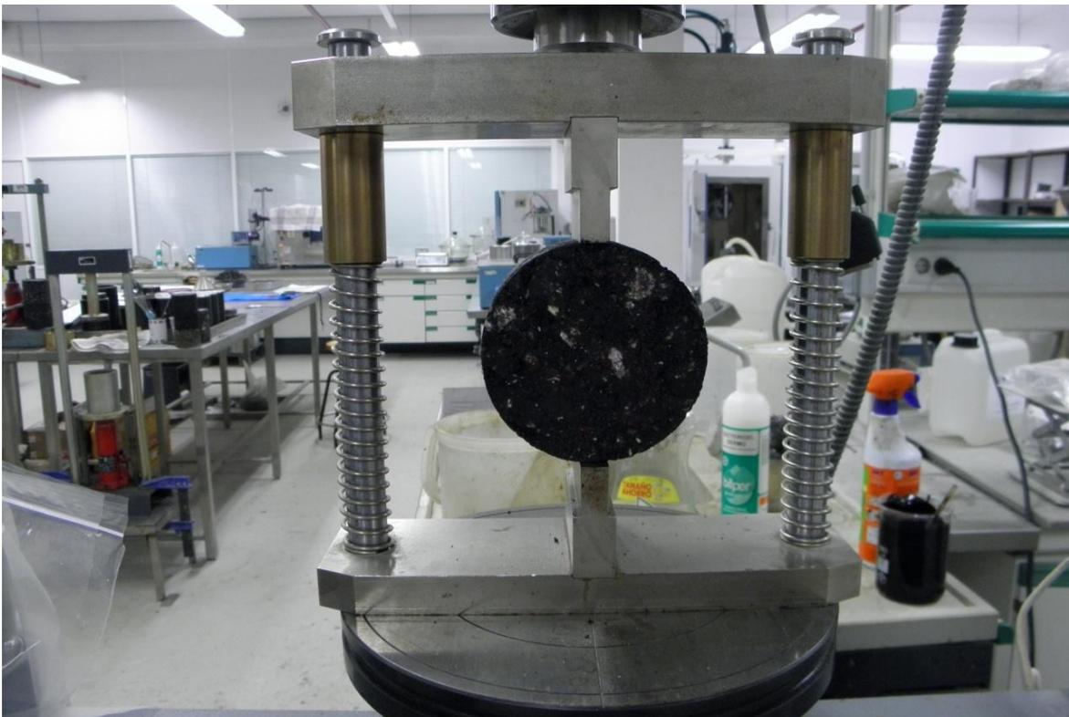
*Figura 6. 4. Ensayo de tracción indirecta para la determinación del índice de resistencia conservada. Detalle de la rotura a tracción indirecta en la prensa estática del Laboratorio de Caminos de la ETSI Caminos, Canales y Puertos de la UDC.*
