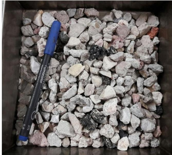
*Figura 3. 3. Fracción 8/16 mm del árido reciclado utilizado.*
