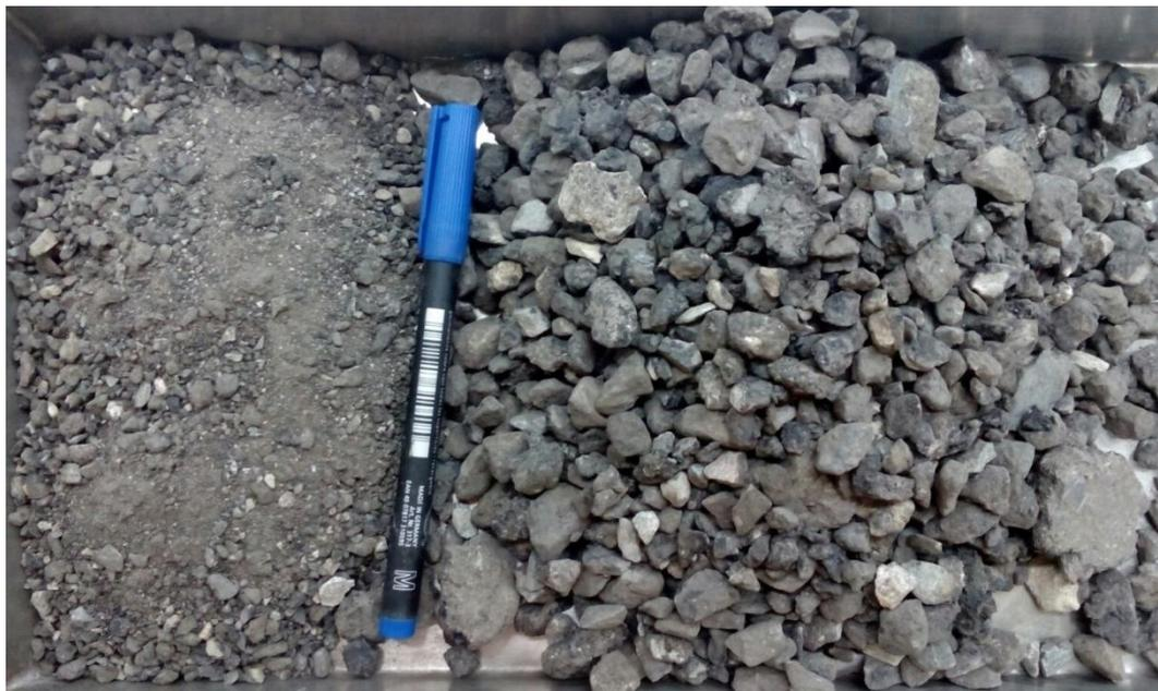
Figura 2. 5. Áridos reciclados con asfalto.
