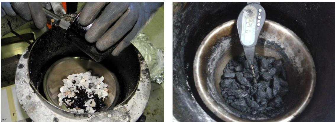
Figura 4. 3. Amasada y control de la temperatura final de la muestra.
