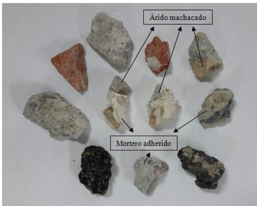
*Figura 2. 7. Detalle de la superficie rugosa de las partículas de AR, así como del mortero adherido a su superficie.*
