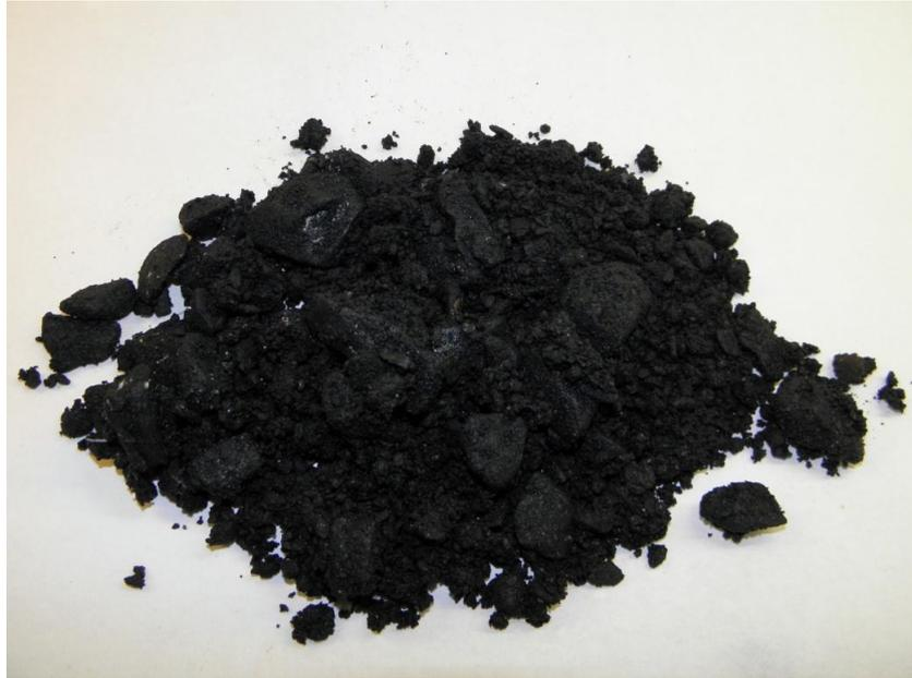
Figura 4. 6. Mezcla 100% árido natural con 105°C de temperatura de árido y 60°C de temperatura de emulsión.
