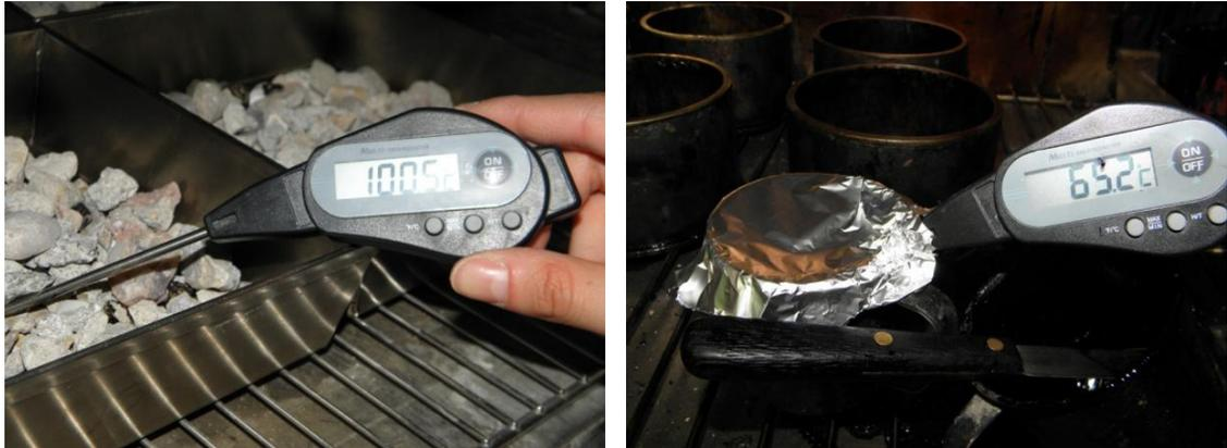
Figura 4. 2. Medida de la temperatura en el árido (fotografía izquierda) y en la emulsión (fotografía derecha).
