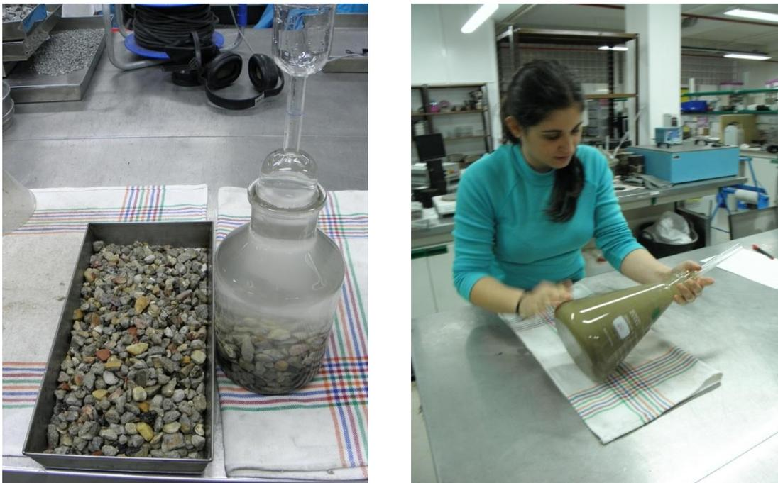
Figura 3. 5. Obtención de las densidades del árido reciclado.
