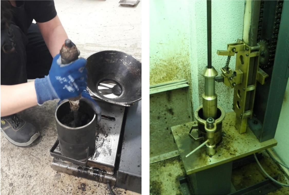
*Figura 5. 8. Compactación de las probetas.*
