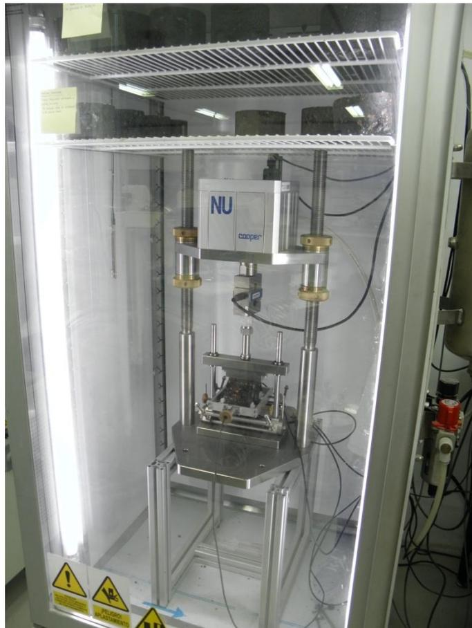
*Figura 7. 1. Detalle de la máquina servo-neumática NU 14 de Cooper con el utillaje para la realización del ensayo de módulo resiliente.*
