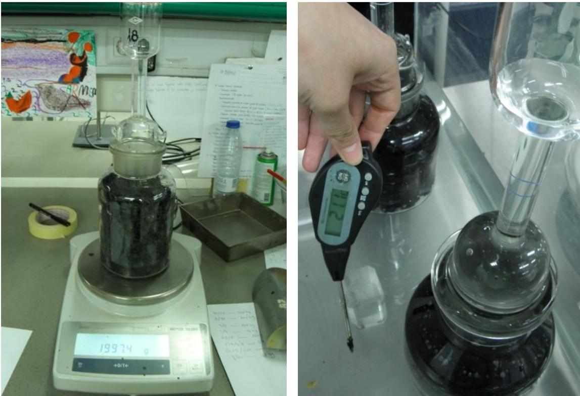
Figura 5. 2. Determinación de la densidad máxima de las muestras.
