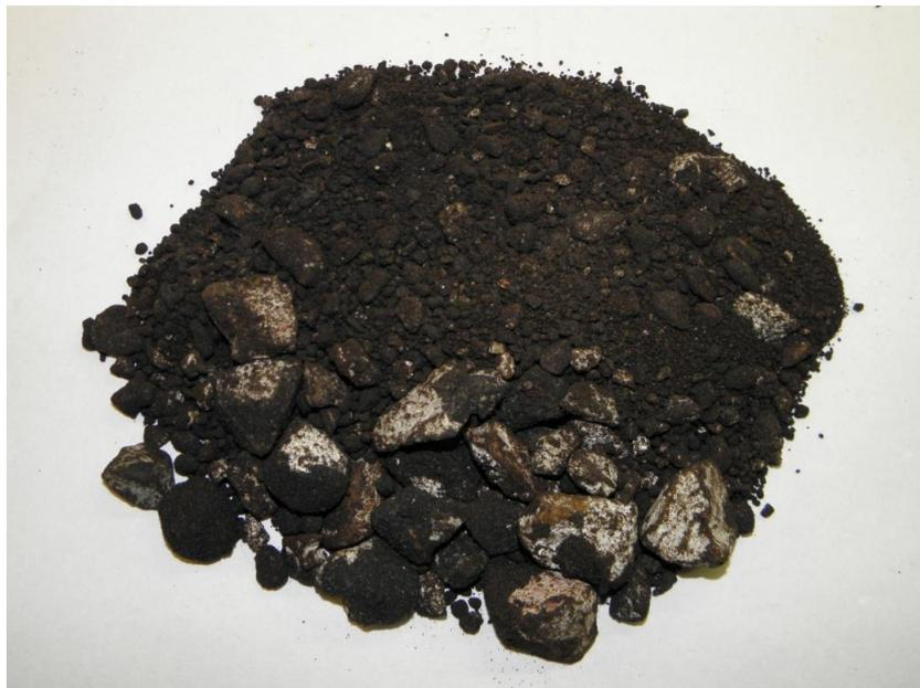
*Figura 4. 9. Mezcla 100% árido reciclado con  $110^{\circ}\text{C}$  de temperatura de árido y  $65^{\circ}\text{C}$  de temperatura de emulsión.*
