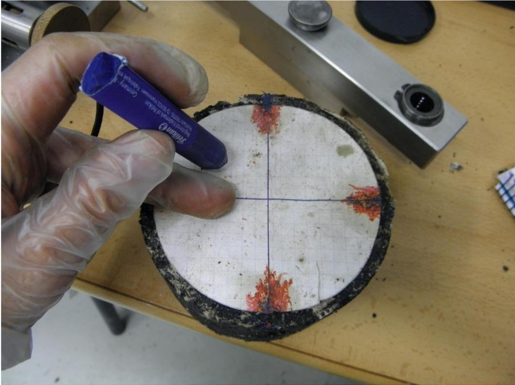
Figura 7. 2. Detalle del trazado de los dos diámetros perpendiculares.
