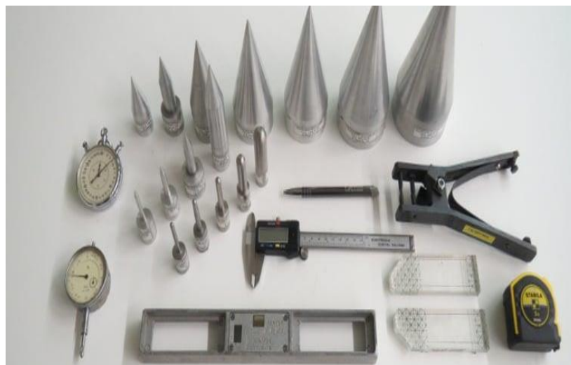
Figura 4.27. Foto de instrumentos de ensayo de acuerdo a la Norma EN 716-2:2008+A1:2013. Furniture - Children's cots and folding cots for domestic use - Part 2: Test methods 8
