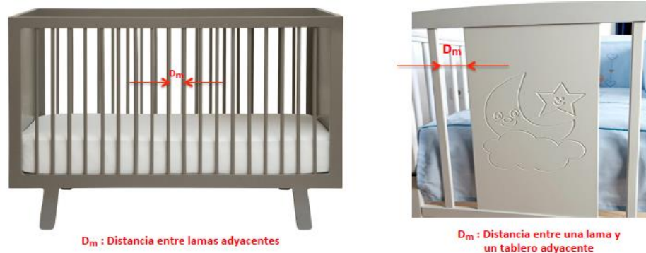
Figura 4.19. Distancia entre elementos estructurales accesibles
