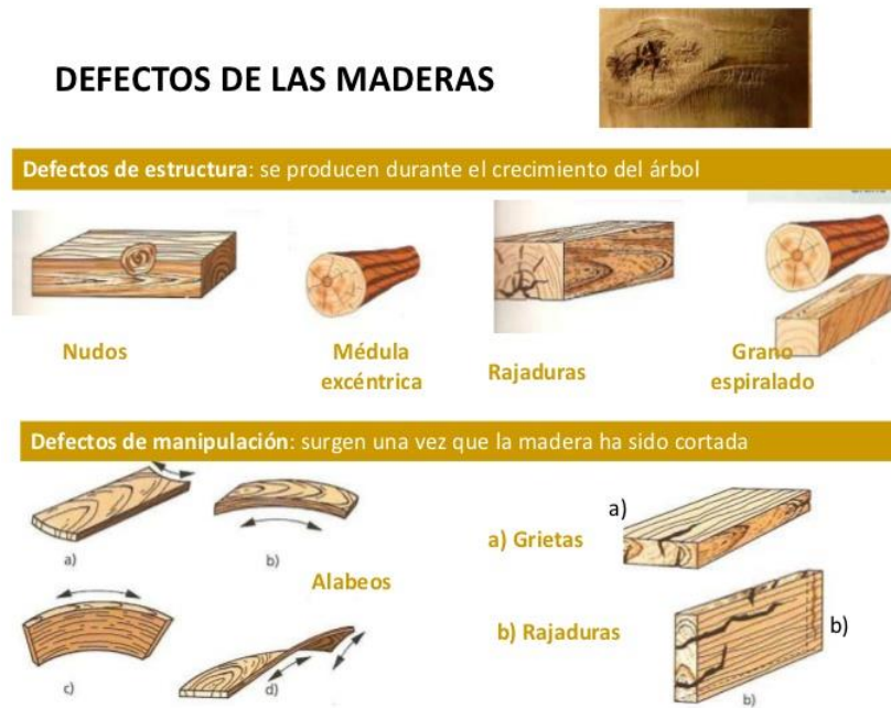
Figura 4.12. Tipos de defectos de la madera como material de construcción 5 de la estructura de la cuna
