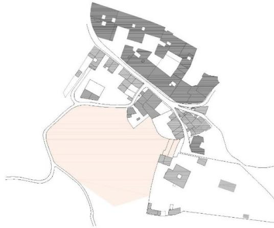
**Escala y posición.** Para la realización del proyecto se analiza el entorno construido, llegando a la conclusión de que la clave para la integración del proyecto con lo existente es la búsqueda de la fragmentación y la escala reducida. Además, se busca la rotación de las piezas para que esa fragmentación sea más visible, intentando conseguir una asimilación formal con lo existente.
