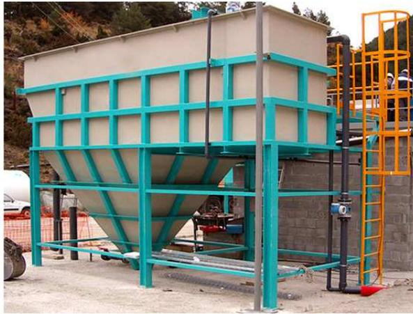
Figura 2.4.2.1 - Modelo tipo de decantador lamelar de un módulo.
