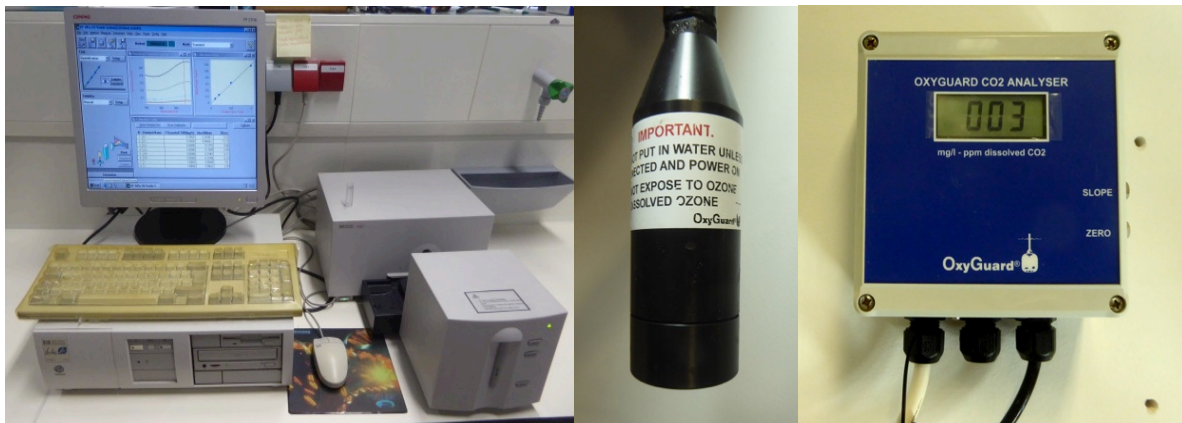
Figura3. Imagen de espectrofotómetro (izquierda), sonda y registrador de CO 2 (centro y derecha).
