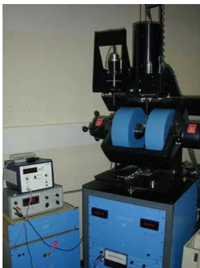
Fig. 1.10. Fotografía del equipo VSM (Universidade de Santiago de Compostela)
