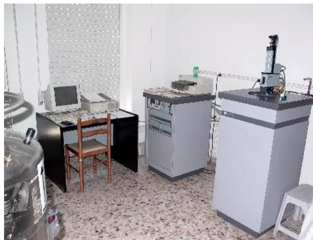
Fig. 1.11. Fotografía del equipo SQUID (Universidad de Santiago de Compostela)
