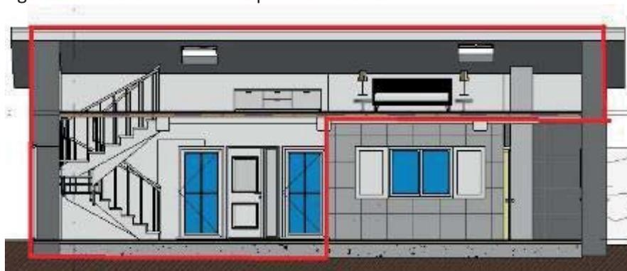
Ilustración 69. Envoltente térmica analizada. Fuente: propia
