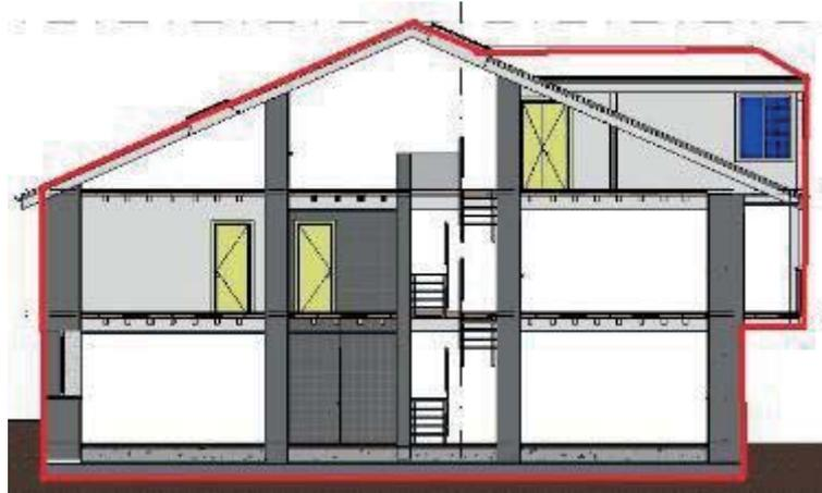
Ilustración 68. Envoltente térmica analizada. Fuente: propia
