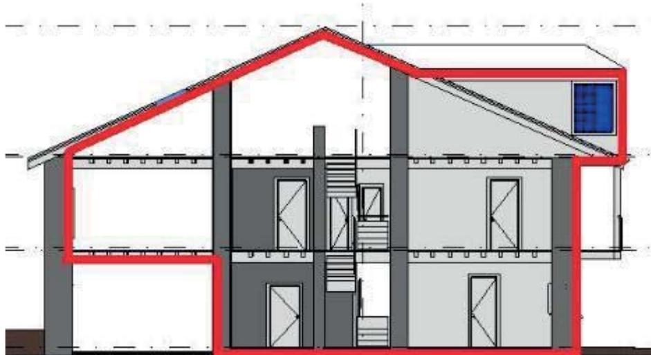
Ilustración 24. Envoltente térmica analizada. Fuente: propia
