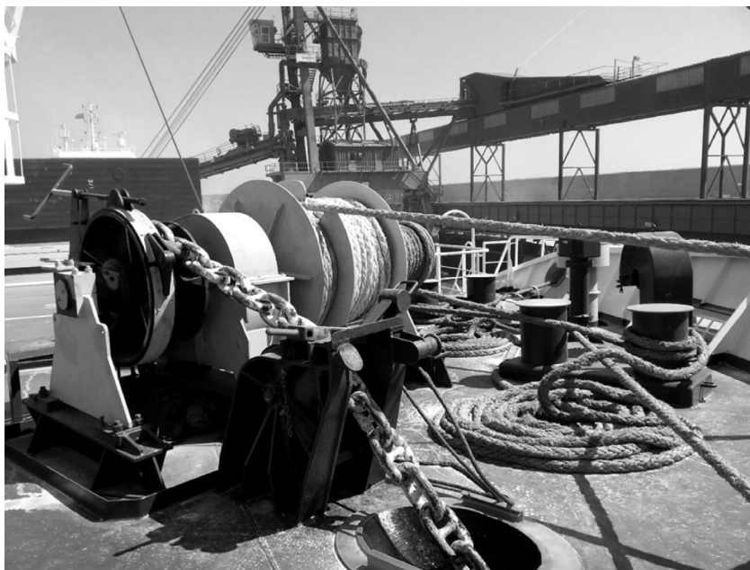
Figura 1. Guincho de amarre combinado (tambor de amarre e molinete para fondear)
