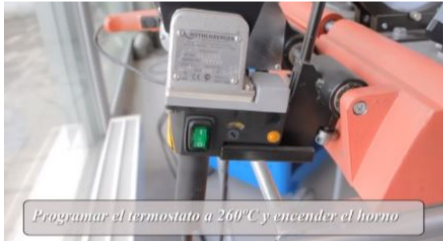
Imagen 8.4.2 Programación termostato unión a testa
