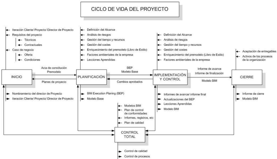
Fig. 37 Interacciones entre grupos de procesos de un proyecto BIM, mostrando entradas y salidas representativas. Fuente Propia
