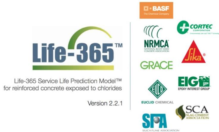
El programa tiene la intención de guiar en la planificación y diseño de estructuras de hormigón expuestas a cloruros en servicio. Está basado en la 2ª ley de Fick y tiene en cuenta más factores para el cálculo como la geometría de la pieza, los efectos de las adiciones y otros cálculos a tener en cuenta en función de la pieza.
