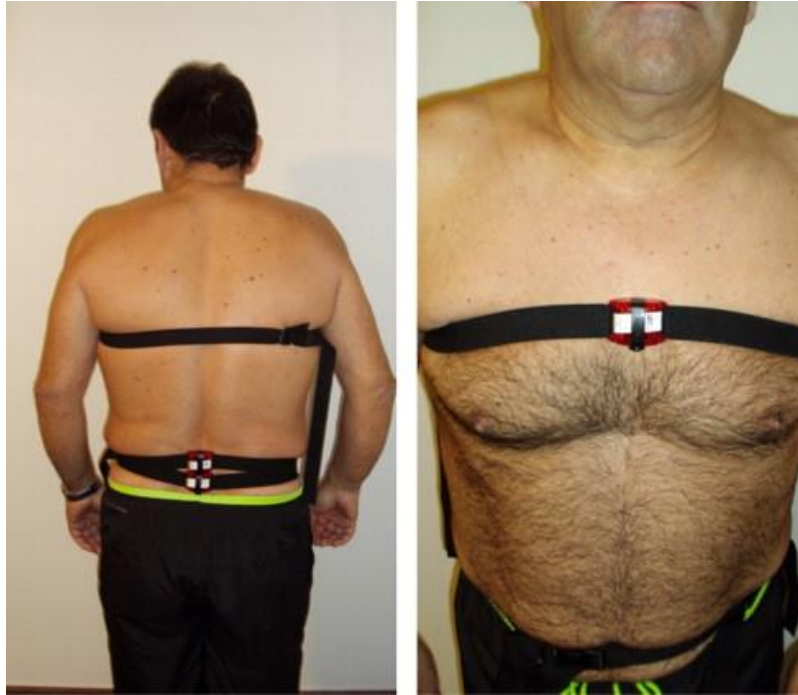
Figura 1. Ubicación de los acelerómetros durante la realización de las pruebas.
