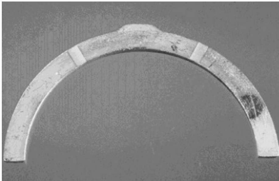
Fig.7.2.2 Semi-cojinete de empuje.
