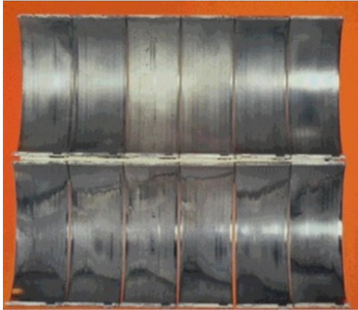
Fig. 10.1.9 Cojinetes de biela con muchas horas de uso, necesario sustituir.
