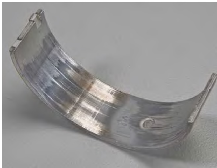
Fig. 11.4.1.1 Típico brillo del pulido por insuficiencia de aceite.
