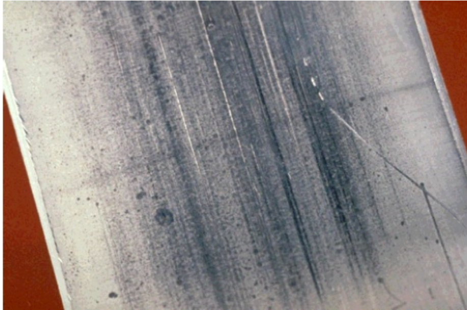
Fig. 10.1.2 Vista aumentada donde vemos un desgaste radial normal.
