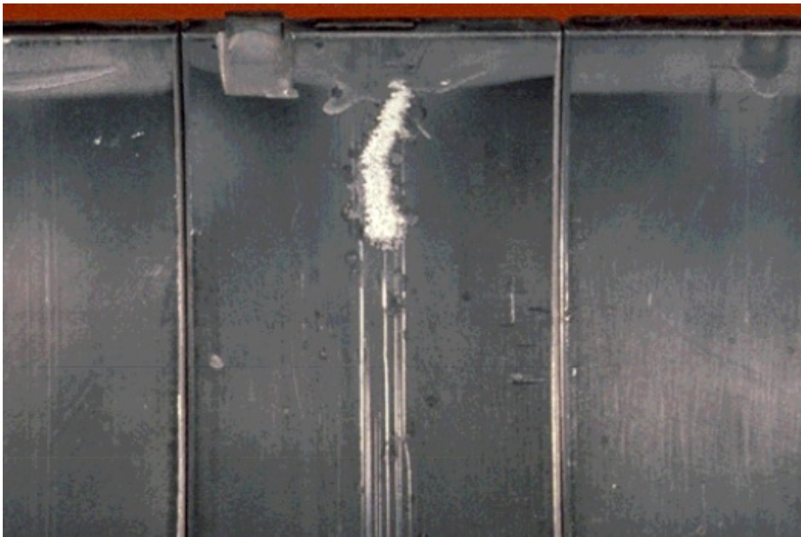
Fig. 10.2.3.1 La erosión por cavitación comenzó a quitar el aluminio de este cojinete y produjo un poco de desgaste por abrasión.
