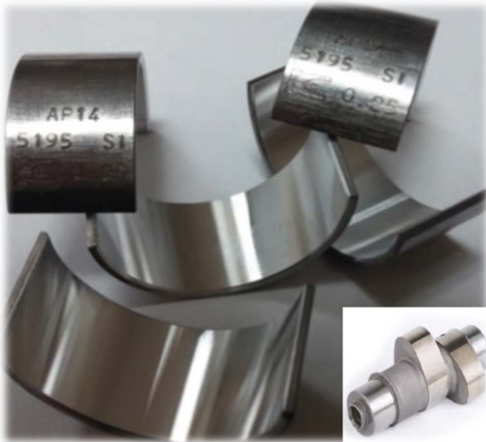
Fig. 8.1.2 Cojinetes fabricados de una aleación de aluminio-silicio (K-788)
