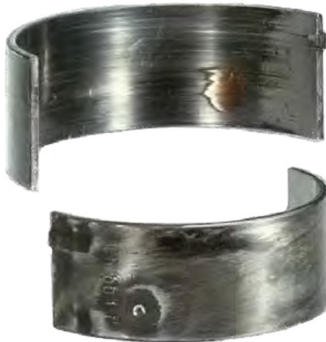
Fig. 11.1.2.1 Vista de la parte delantera y posterior de un cojinete donde se aprecia el desgaste localizado en una zona.
