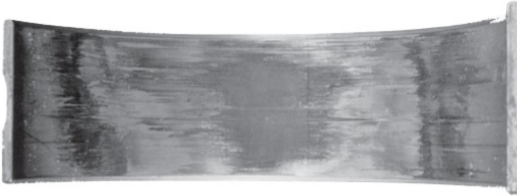
Fig. 11.6.1 Muestra los daños por corrosión en el cojinete.
