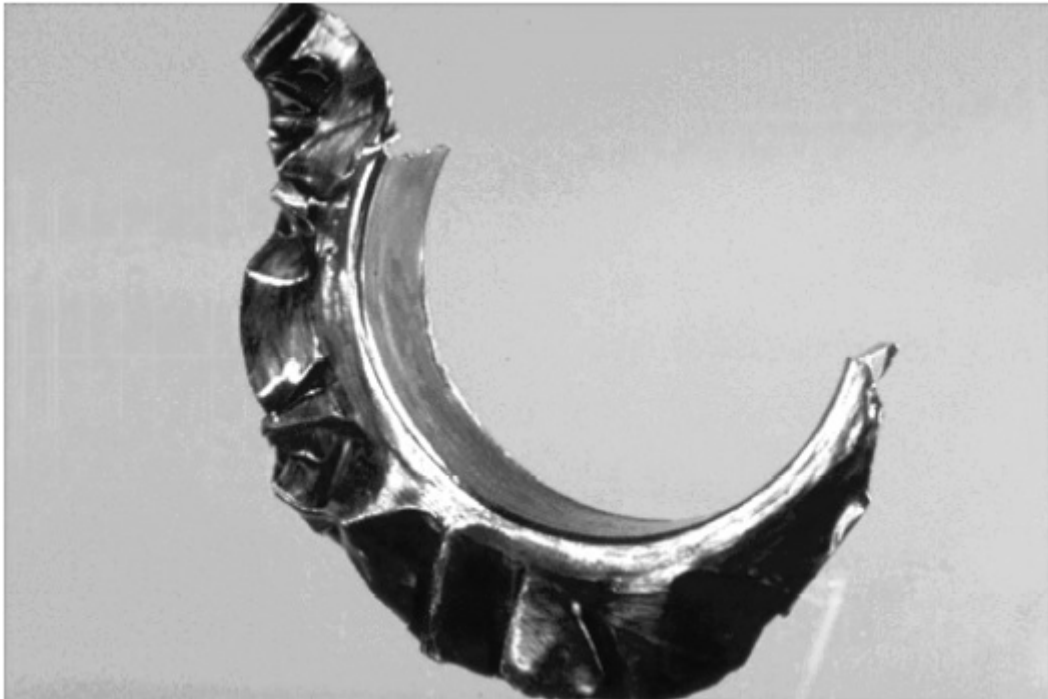
Fig. 10.2.1.1 Tapa de biela totalmente deformada.
