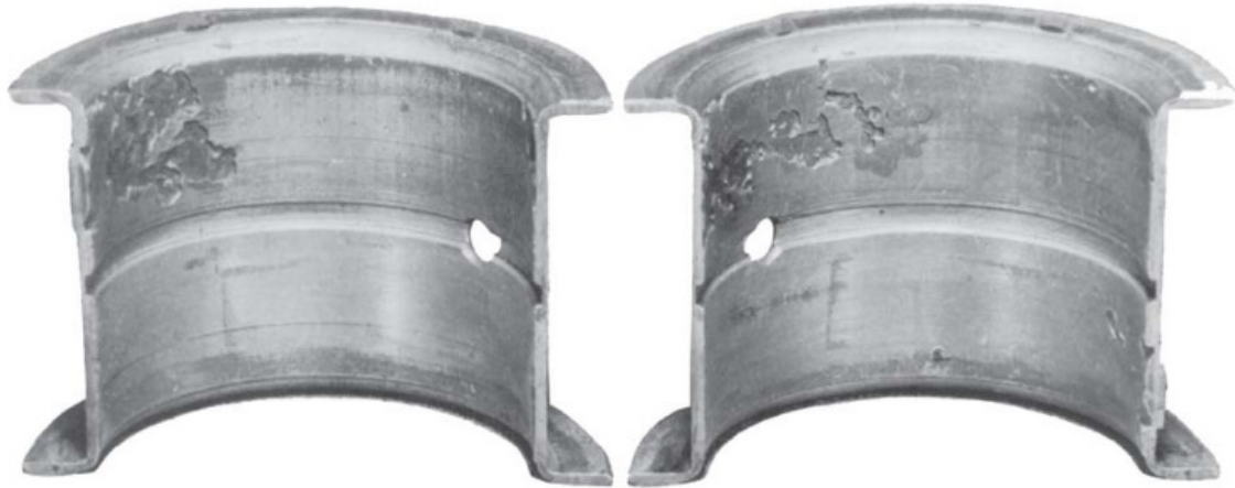
Fig. 11.2.1.1 Semi-cojinetes desgastados debido a un mal montaje.
