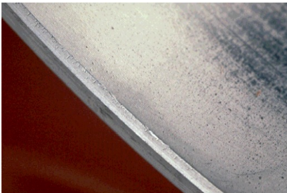
Fig. 10.1.3 Aumento del borde exterior de un semi-cojinete
