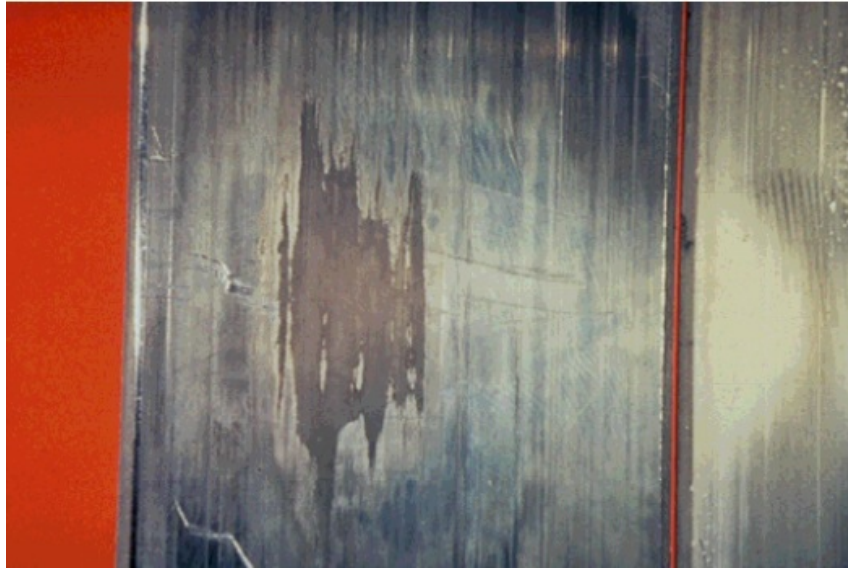
Fig. 10.1.6 Fatiga normal del Babbitt después de muchas horas y regímenes de sobrecarga.
