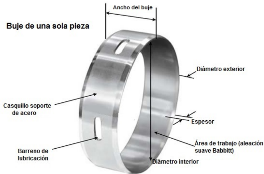
Fig. 6.2.1 Cojinete del tipo casquillo o bushing.
