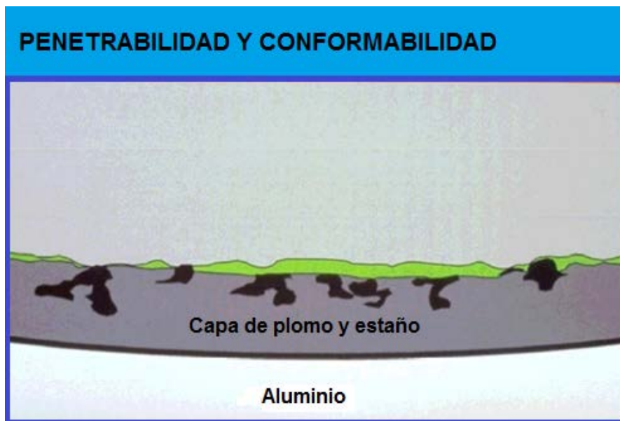
Fig. 7.1.3.1 Las zonas sombreadas en negro son partículas de suciedad o polvo incrustadas a la aleación del metal.
