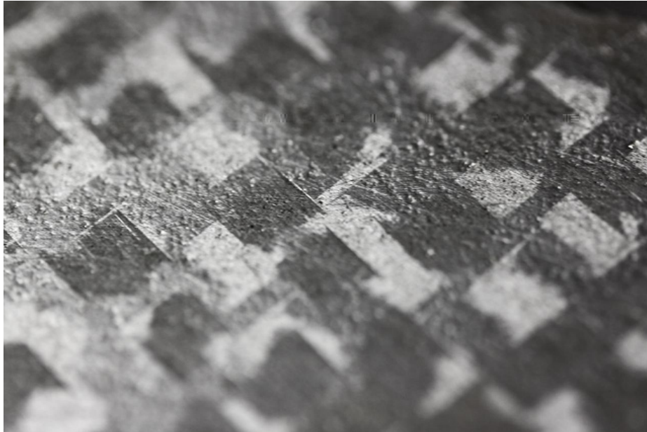
Fig. 6.6.1 Textura lograda con el raspado manual en la superficie de un cojinete plano.
