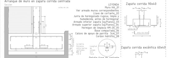
**LA ALTURA DEL POZO DE CIMENTACIÓN ES VARIABLE SEGÚN EL PLANO DE CALEFATAS, QUE NOS INDICA LA ALTURA DEL ESTRATO DE RESISTENTE. Ver planos estudio geotécnico y excavación.**
