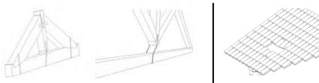
Fig. I.5.25. Mecanismos de colapso: M15 y M16 (Ficha modelo B-DP)
