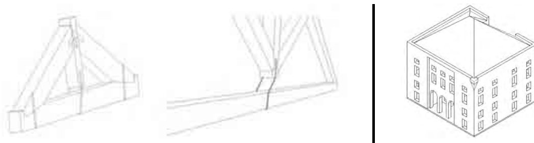
Fig. I.5.38. Mecanismos de colapso: M15 y M17 (Ficha modelo B-DP)
