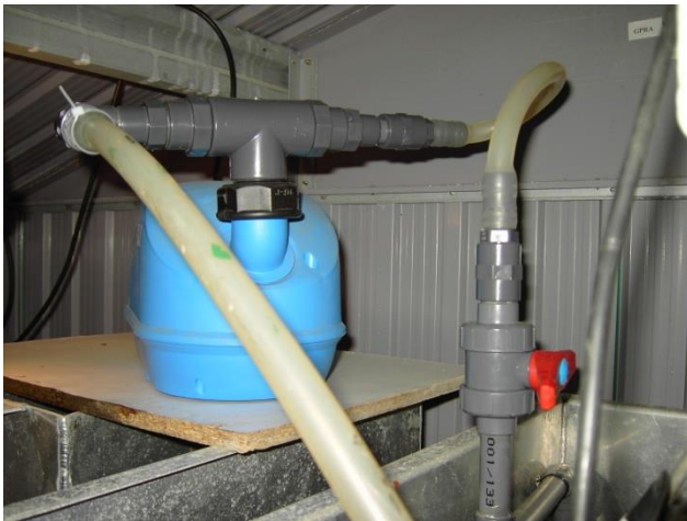
Figura 3.8.- La soplante (izda.) y el sistema de reparto de aire al seno líquido del reactor (dcha.). El sistema de reparto de aire se hace mediante 2 tubos de PVC de 20 mm, independizados con válvulas.
