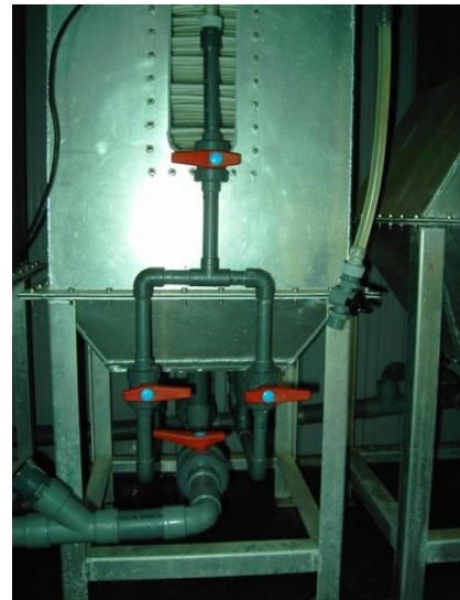
Figura 3.8.- La soplante (izda.) y el sistema de reparto de aire al seno líquido del reactor (dcha.). El sistema de reparto de aire se hace mediante 2 tubos de PVC de 20 mm, independizados con válvulas.
