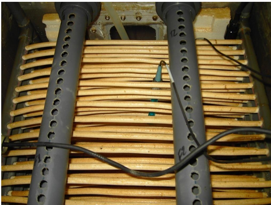
Figura 3.21.- Imagen de las membranas tubulares microporosas recubiertas de biopelícula nitrificante.
