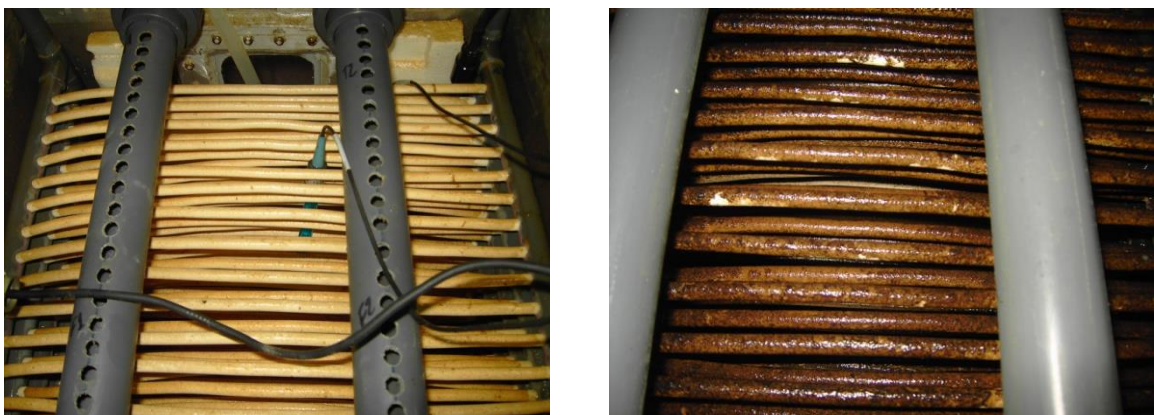
Figura 4.6.- Imágenes de las biopelículas desarrolladas sobre las membranas tubulares aireadas: nitrificante (izda.) y mixta de nitrificación/desnitrificación (dcha.).
