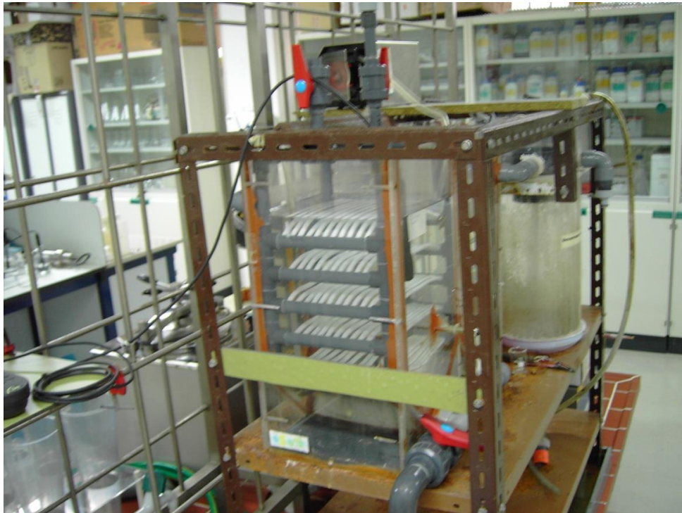
Figura 3.12.- Imagen del reactor de membrana tubular a escala de laboratorio utilizado en los ensayos de aireación física con las membranas limpias.
