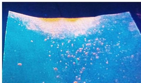
**Figura 24.** Fotografía de la emisión del material *NPa* bajo luz UV de 365 nm.
