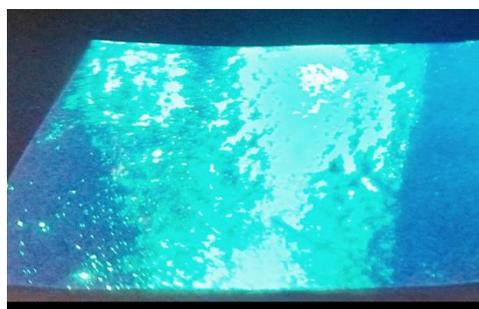
Figura 20. Fotografía de la emisión del material NPc bajo luz UV de 365 nm.
