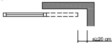
Figura 2.1 Holgura para evitar atrapamientos
