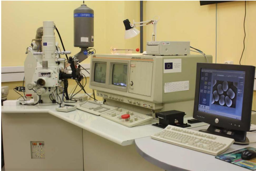
Figura 4. 6 Equipo de microscopía electrónica de barrido<sup>[10]</sup>
