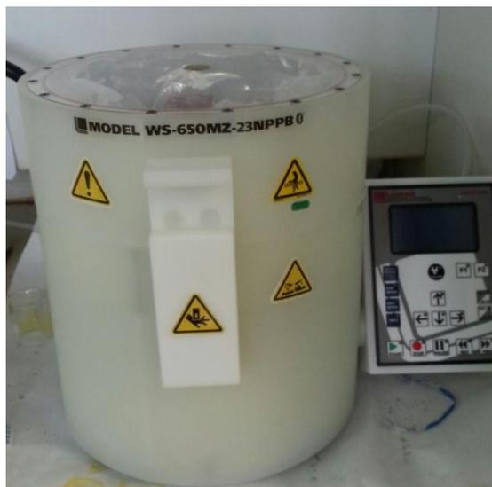
**Figura 4. 1** Fotografía del equipo empleado para la deposición mediante “*spin-coating*”
