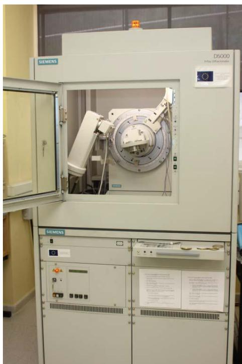
Figura 4. 5 Equipo de difracción de Rayos-X<sup>[7]</sup>
