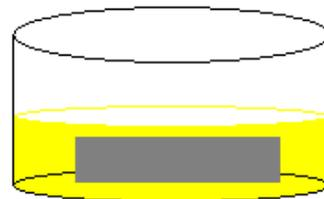
Figura 3. 3 Representación del método de “dip-coating”
