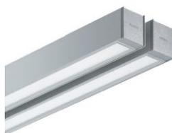
L02 // Luminaria PHILIPS Celino TPS680/682 de colocación colgada, con una altura mínima de 2m con la cota de suelo acabado (CTE-DB-SUA4 Ap. 2.2) con acabado en aluminio y dos lámparas TL5 de potencia 28W.
