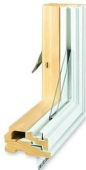
Se han utilizado carpinterías con altas prestaciones térmicas y diseño acorde con el proyecto. Se trata de una carpintería a base de perfiles de madera maciza de arce con revestimiento exterior en aluminio tipo Andersen A-Series Frenchwood. Se ha combinado el uso de vidrios de color neutro bajo reflectantes tipo Low-E Glass triples y dobles con cámaras rellenas de gas argón, de altas prestaciones térmicas.
