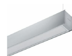
Imagen 4. LED PHILIPS de montaje suspendido tipo CELINO - LIGHT BEAM, para colgar de techos de la zona de entrada. Óptica de microlamas tridimensionales de aluminio. Fabricada de aluminio anodizado natural. Las medidas son: 76mm de alto, 1220mm de largo y 71 de ancho.
