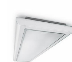
Imagen 5. LED PHILIPS DE SUPERFICIE SCHOOLVISION TCS477, para interiores de salas de profesores, cocina y despachos. Montaje en techo con las siguientes dimensiones: 80mm de alto, 1540 de largo y 332mm de ancho. Controles de alumbrado, con fotocélulas y detectores de presencia integrados. No posee elemento difusor. Óptica de microlentes de policarbonato.
