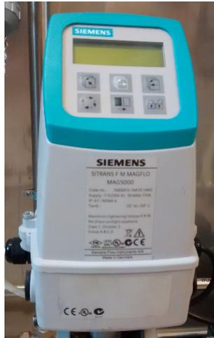
**Figura 7.1.2.3** – Caudalímetro Sitrans F M de Siemens
