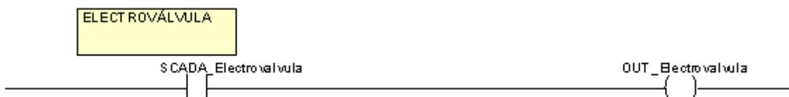
Figura 8.1.3.11 – Activación de la electroválvula
