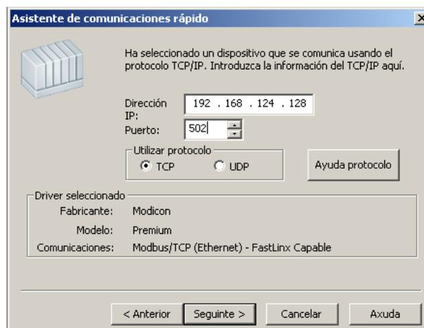
**Figura 8.5.1.3** – Configuración de dispositivo de direcciones
