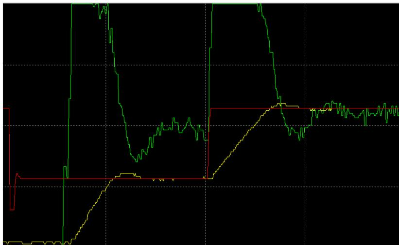
**Figura 8.3.3.4** – Control PID simple con parámetros optimizados con cambio de consigna (207seg)
