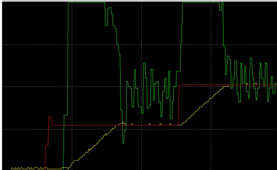
**Figura 8.4.3.2** – Control PID avanzado con RLS de 1 polo y  $K_M=0.45$  (147seg)
