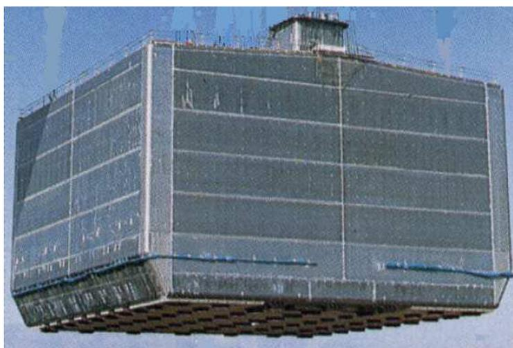
**Figura 1.1. Tanque IHI SPB tipo B para GNL**
