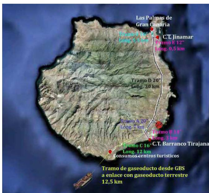
Figura 5.13. Representación de la GBS y del gasoducto propuesto
