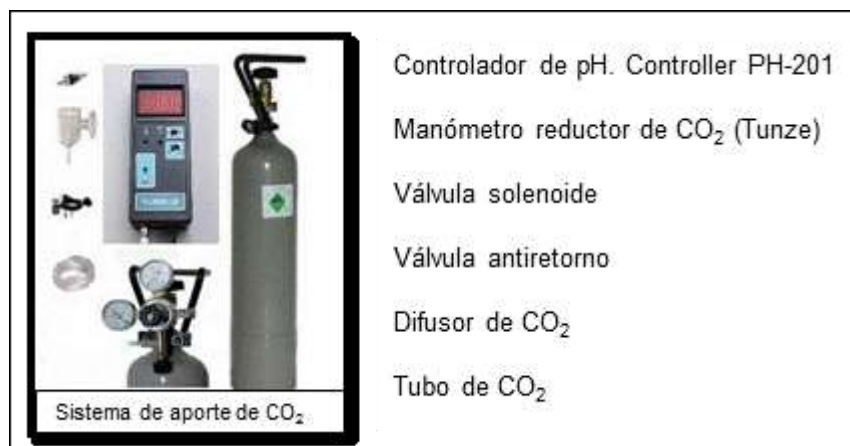
Figura 10. Componentes del sistema de aporte de CO 2 del acuario.
