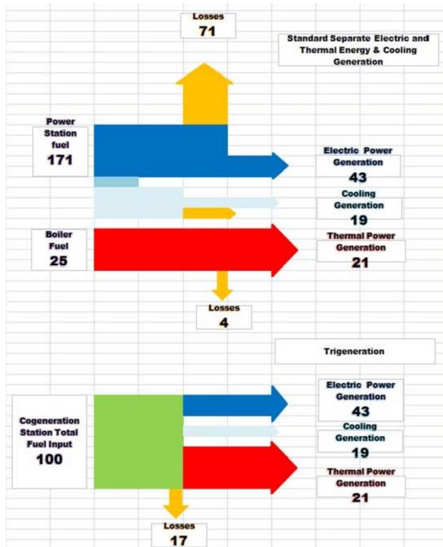
Figura 2: Comparativa producción energía eléctrica y térmica por separado y con cogeneración. Fuente: (Alpine Group, 2012)
