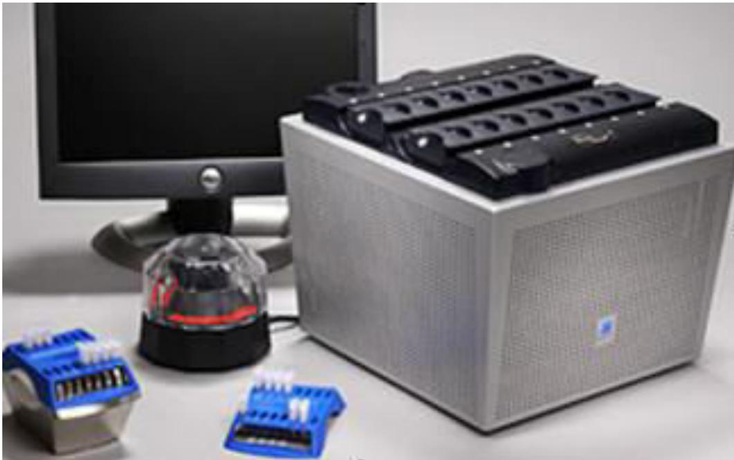
Figura 3. Equipo de PCR a tiempo real Smart Cycler II (Cepheid®).
